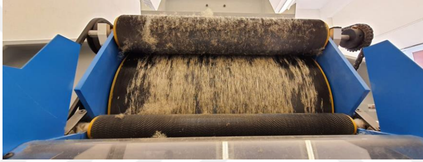
Şekil 2. 4 %100 Kenevir elyafı tarama
