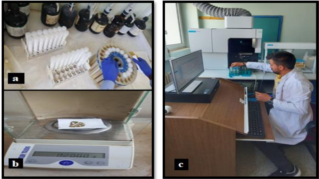
Şekil 3.6. Kurutulmuş ve öğütölmüş asma yapraklarının tartılması (a), mikrodalga setine yerleştirilmesi (b) ve besin elementi değeri lerinin okunması (c)
