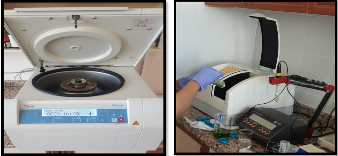
Şekil 3.4. Örneklerin antrifüj cihazına konulması (solda) ve spektrofotometre cihazında okunması (sağda)
