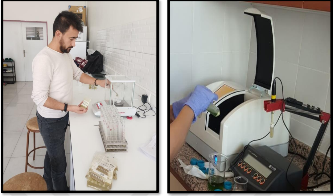
Şekil 3.5. Asma yapraklarının tartılması (solda) ve demir şelatlama aktivitesinin spektrofotometre cihazında okunması (sağda)
