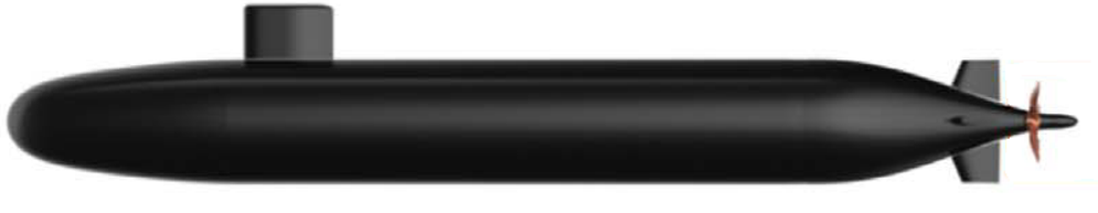
Şekil 3.4 E1619 Model Pervanesinin eklendiği AFF-8 geometrisi
