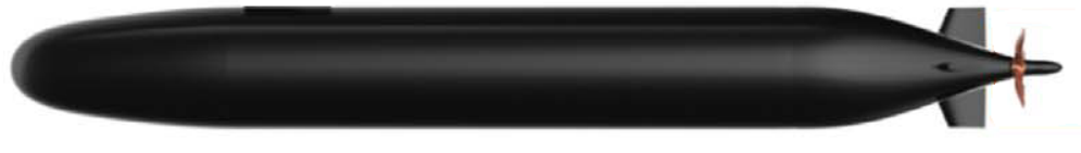
Şekil 3.5 E1619 Model Pervanesinin eklendiği AFF-3 geometrisi
