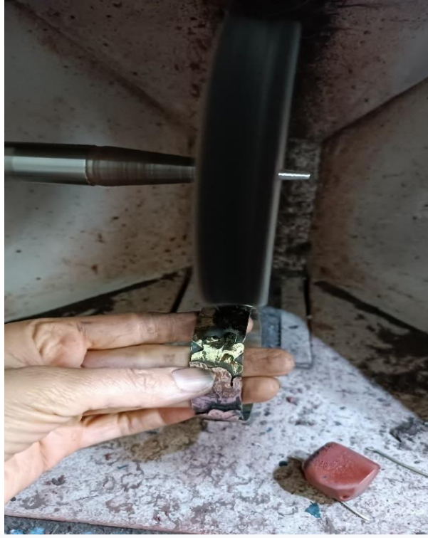
Fotoğraf No 131: “Hareketli yapraklar” isimli bilezik tasarımı cila aşaması, Haziran 2023.
