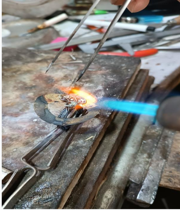
Fotoğraf No 171: “Sakura” isimli yüzük tasarımı kaynak aşaması, Haziran 2023.
