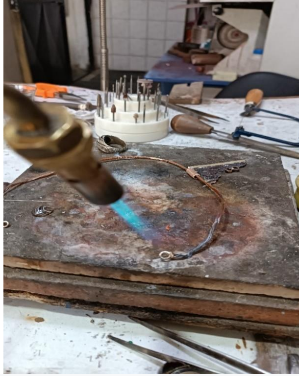
Fotoğraf No 116: “Ağaç kabuğu” isimli kolye ucu kaynak aşaması, Haziran 2023.
