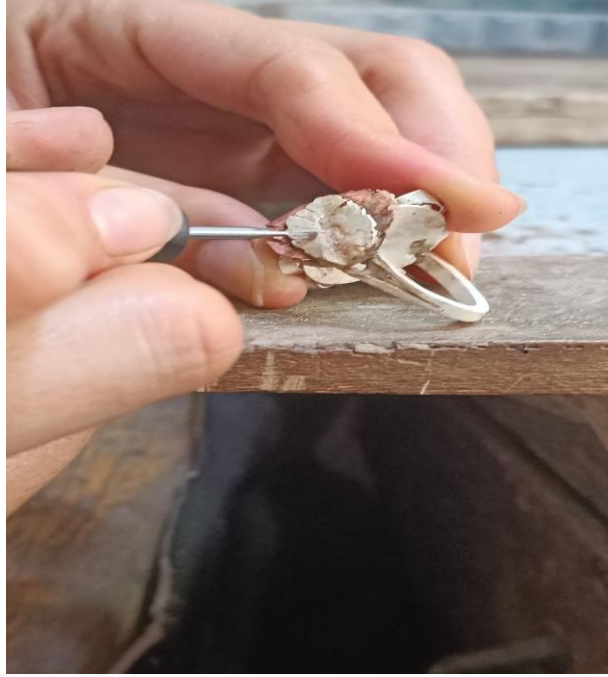
Fotoğraf No 156: “Ortanca” isimli yüzük tasarımı yüzey doku aşaması, Haziran 2023.
