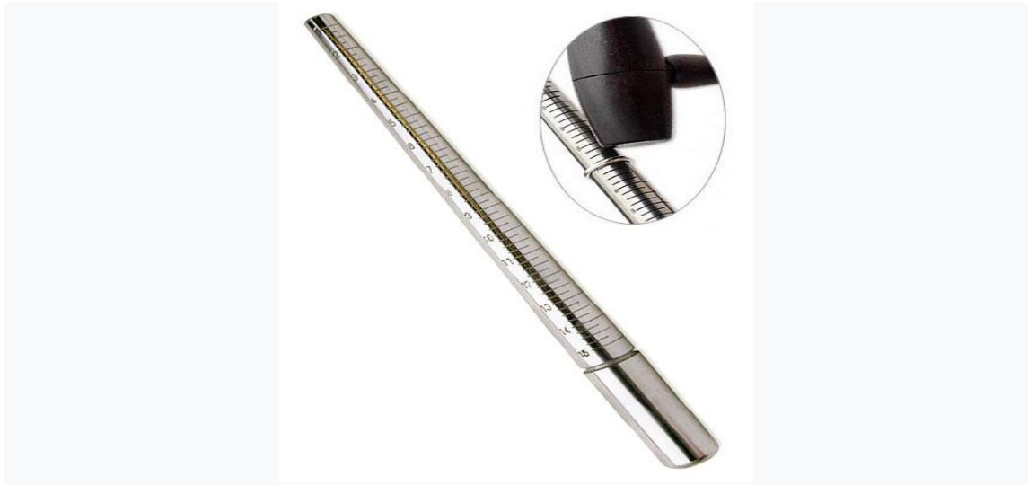
Fotoğraf No 15: Malafa, ( https://atolyeargentum.com/f/kuyumcu-at%C3%B6lyeleri%CC%87nde-kullanilan-el-aletleri%CC%87---1- , Eriřim Tarihi: 15 Temmuz 2023).
