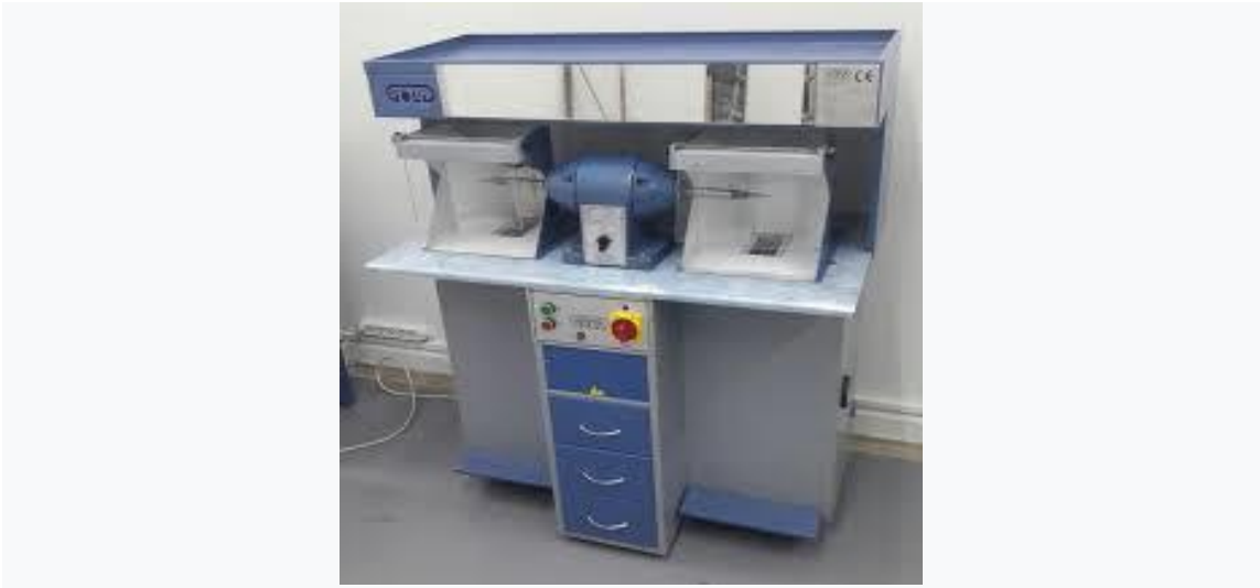
Fotoğraf No 19: Cila motoru, ( https://www.mangirkuyumcumalzemeleri/posts/3415701348461031/?locale=ar_AR , Erişim Tarihi: 15 Temmuz 2023).
