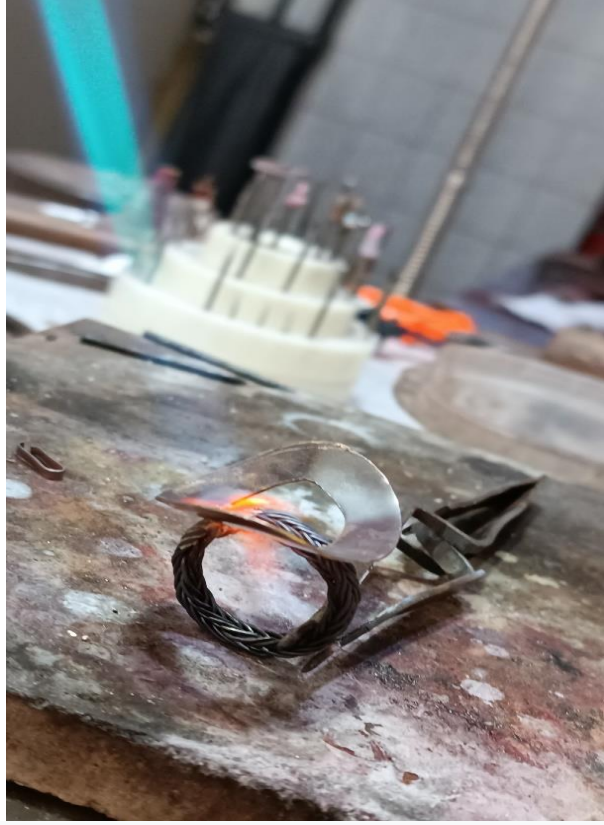
Fotoğraf No 170: “Sakura” isimli yüzük tasarımı kaynak aşaması, Haziran 2023.
