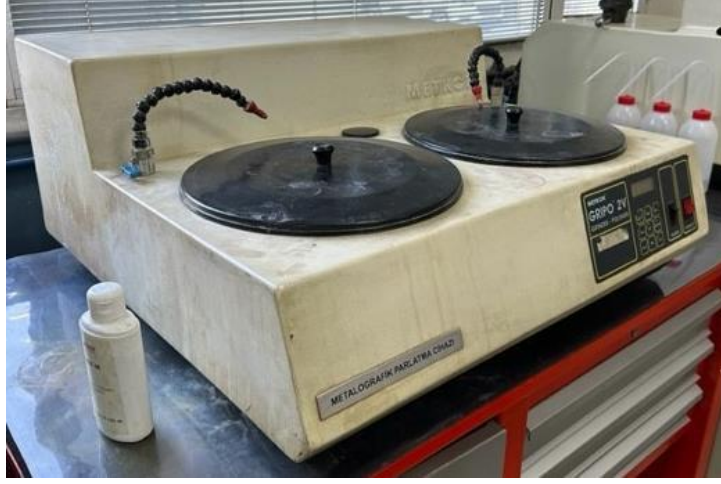
Şekil 3.23. Metkon GriPO 2V Zımparalama ve Parlatma Cihazı
