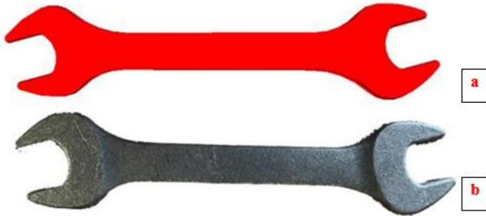
Şekil 4.4.a) Çapak Alma İşlemi Sonrası Simülasyondan Elde Edilen Ürün b) Gerçek Prosesten Elde edilen Ürün
