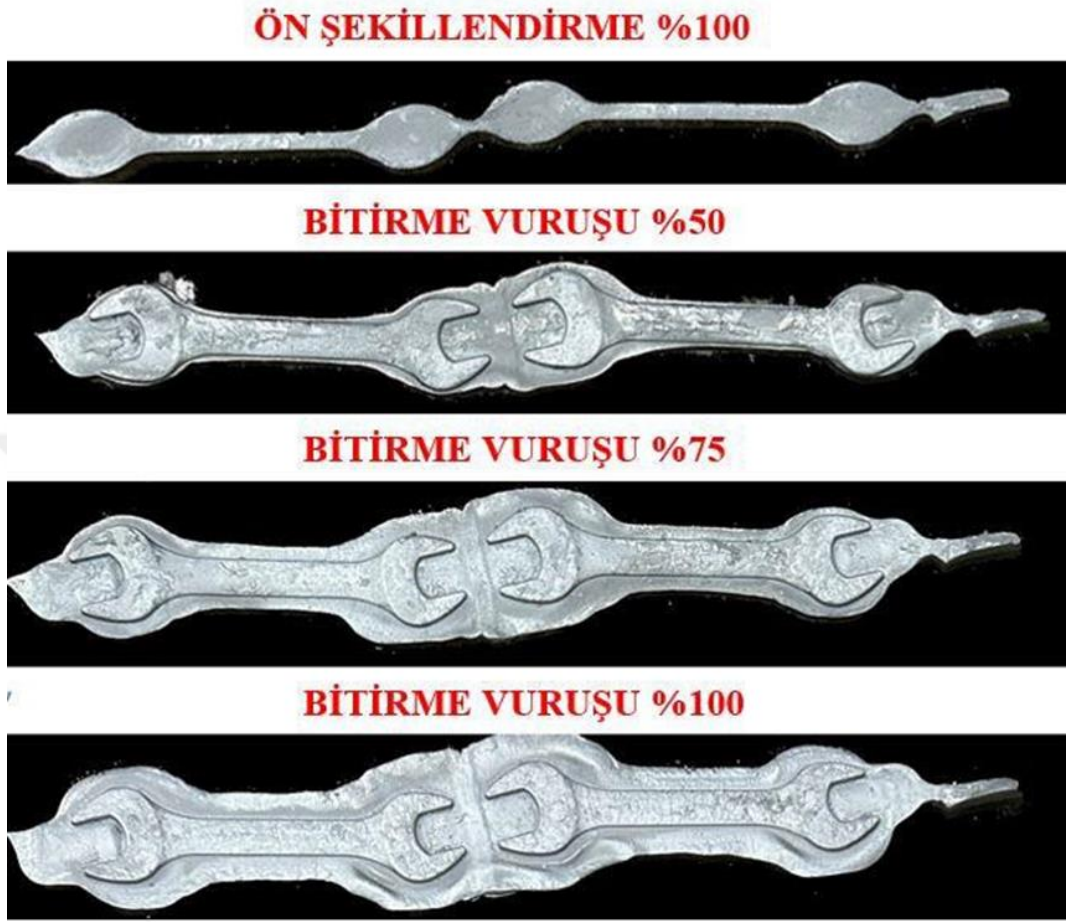
Şekil 4.2. Sıcak Dövme İşlemi Prosesi Sonucu Oluşan Ürünün Yüzde Yükleme Miktarına Göre Değişimi
