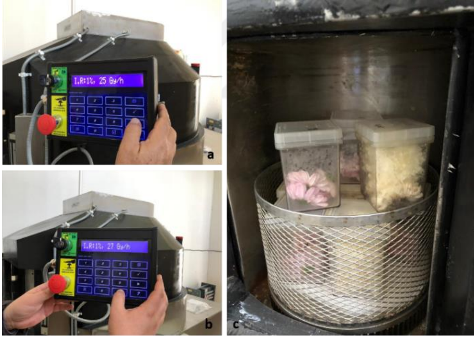
Şekil 3.10. Dilsî çiçek eksplantlarının gama kaynağında ısınlanması (a, b, c)
