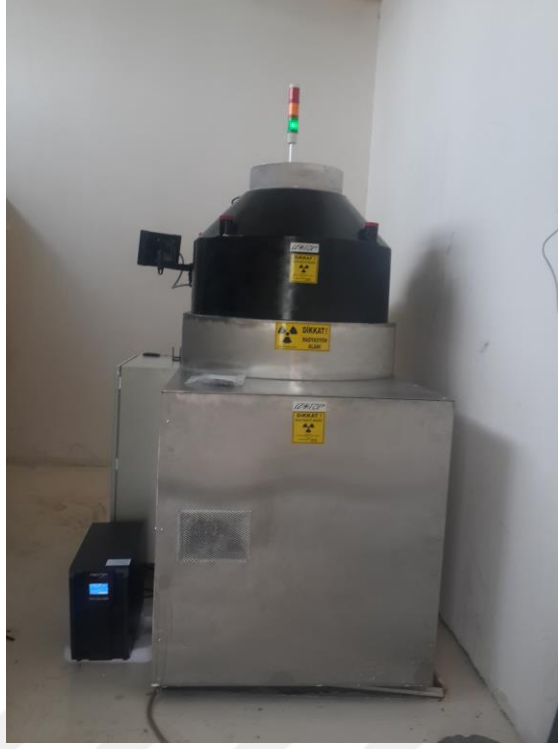
Şekil 3.7. İzotop, Ob-servo Sanguis B/01 model 360° döner tablalı klimatize Gama ( \text{Co}^{60} ) kaynağı
