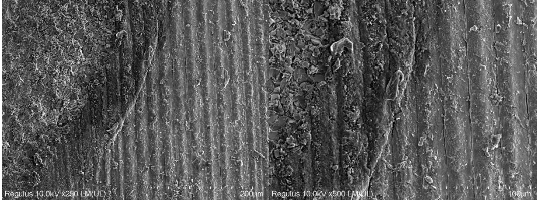
Şekil 4.20. THER-CSE/EVERX grubunun koparılmamış örneğinden alınan 250×, 500× büyütmedeki SEM görüntüleri
