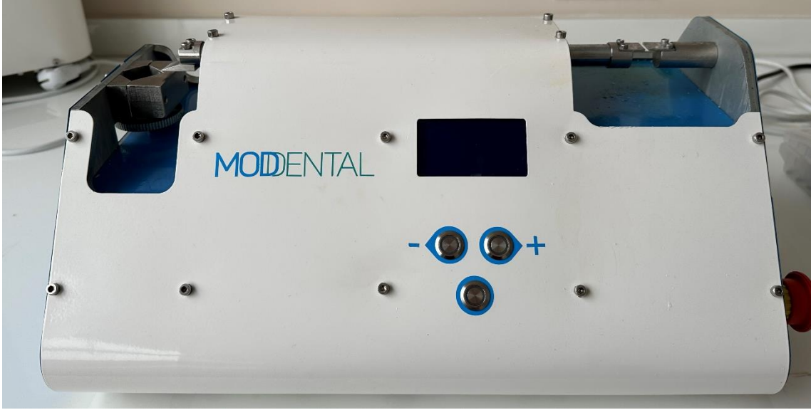
Şekil 3.14. Araştırmada kullanılan mikrogerilim bağlanma dayanımı test cihazı
