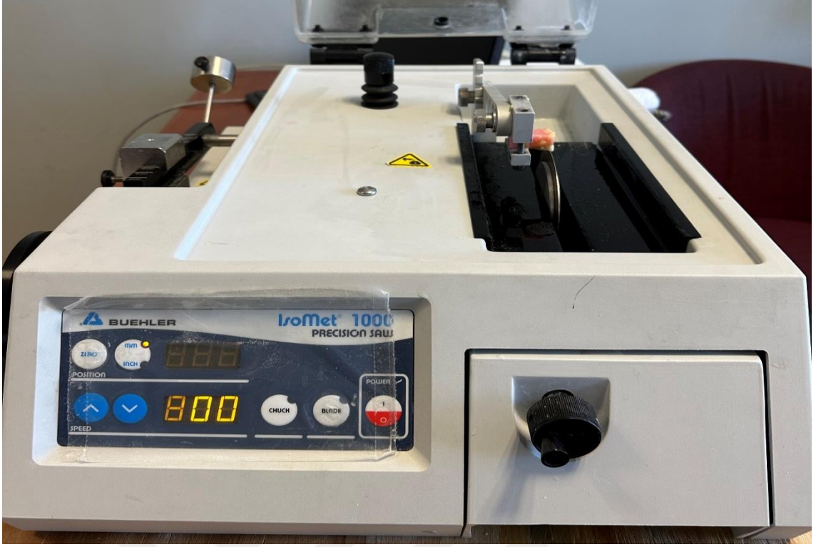
Şekil 3.10. Su soğutmalı kesme cihazı
