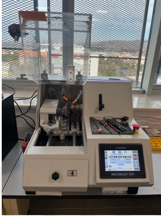
Şekil 2.8. Örneklerden kesitler alınmasını sağlayan mikrocut cihazı (Metkon Micracut 201)
