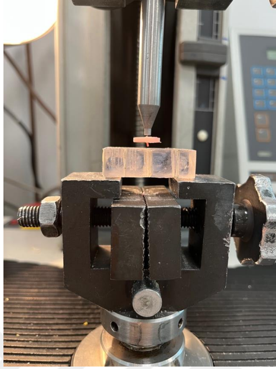
Şekil 2.10. Kesitlere itme bağlanma dayanımı testi (push-out bond strength) uygulanması
