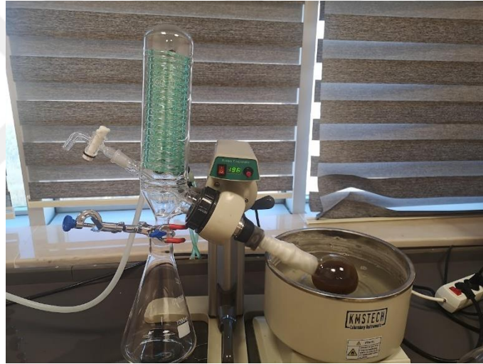
Görsel 17. Rotary Evaporatorde Ekstrakt Çözücülerinin Uçurulması (Selime Semra EROL, 2021)
