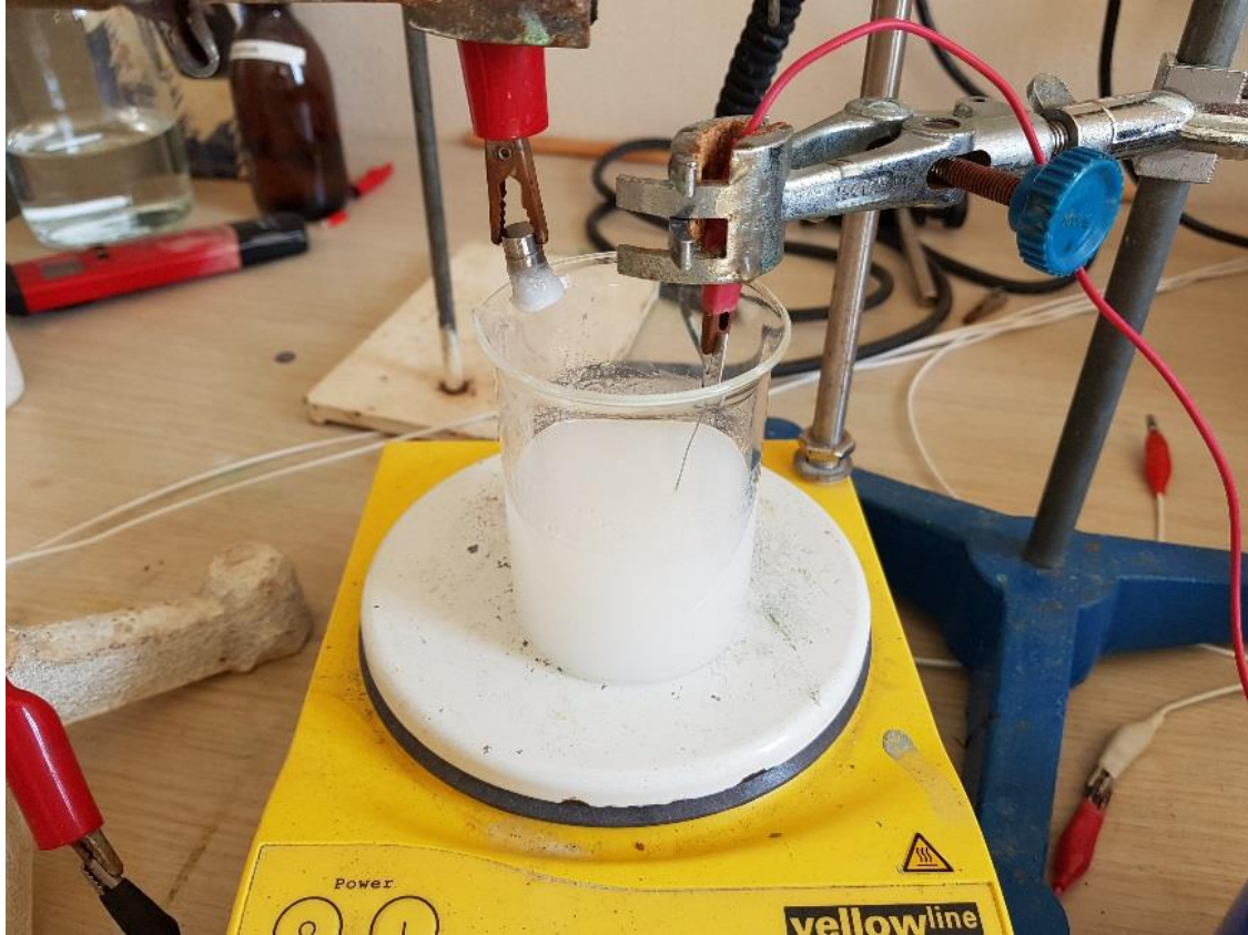
Şekil 4.5. Elektroforetik yöntemle kaplanan HA/CTS numunesi
