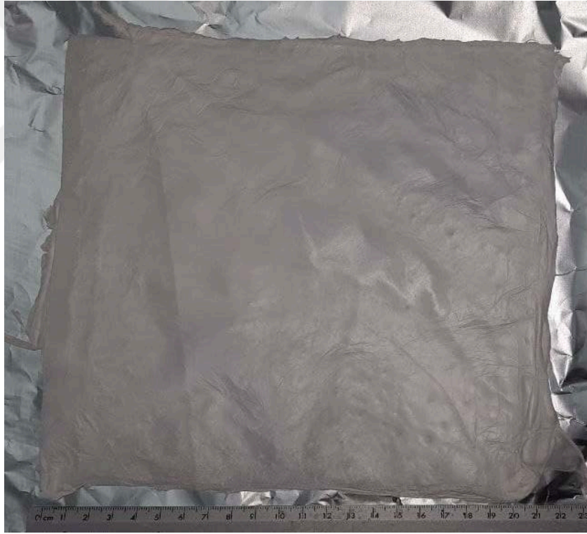
Şekil 3.7. Birinci Katmandaki PTFE@PVA nanofiberi
