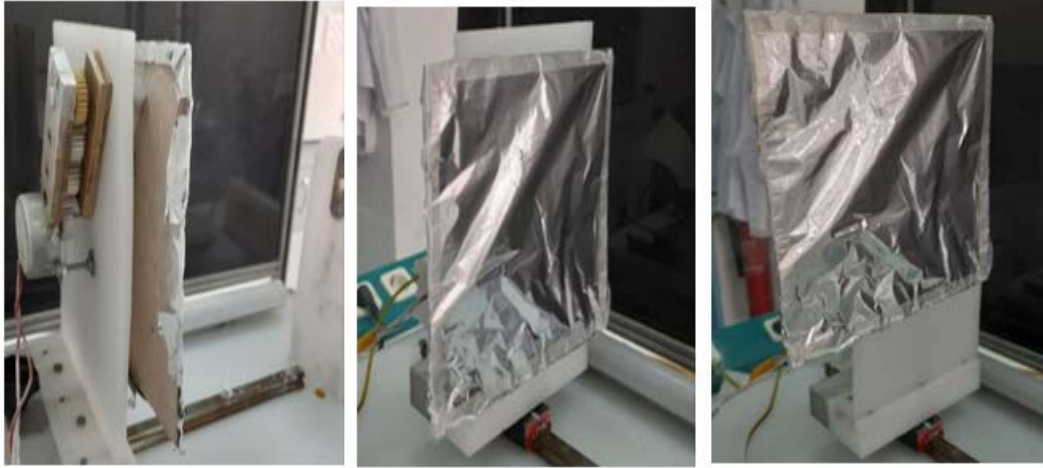
Şekil 3.6. 20cm x 20cm hareketli toplayıcı plaka
