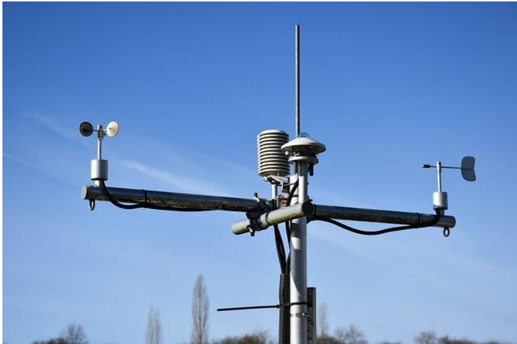
Şekil 1.8. Rüzgar hızını ölçmede kullanılan anemometre cihazı (URL 7)
