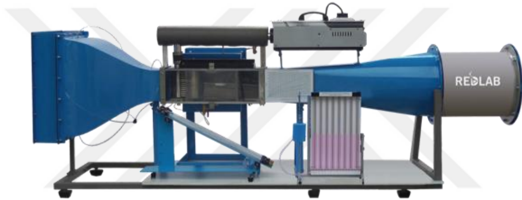
Şekil 1.15. Rüzgar tüneli deney seti (URL14)
