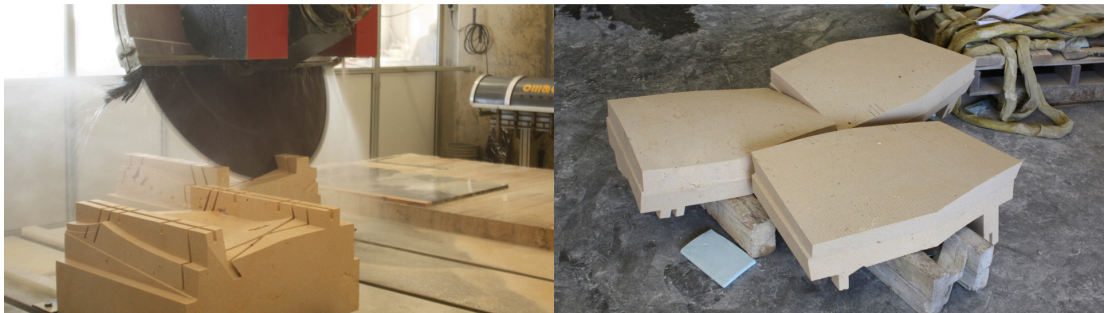
Şekil 3.6: Karmaşık kubbe geometrisi için stereotomik çalışma (Rippmann, M., & Block, P., 2011)
