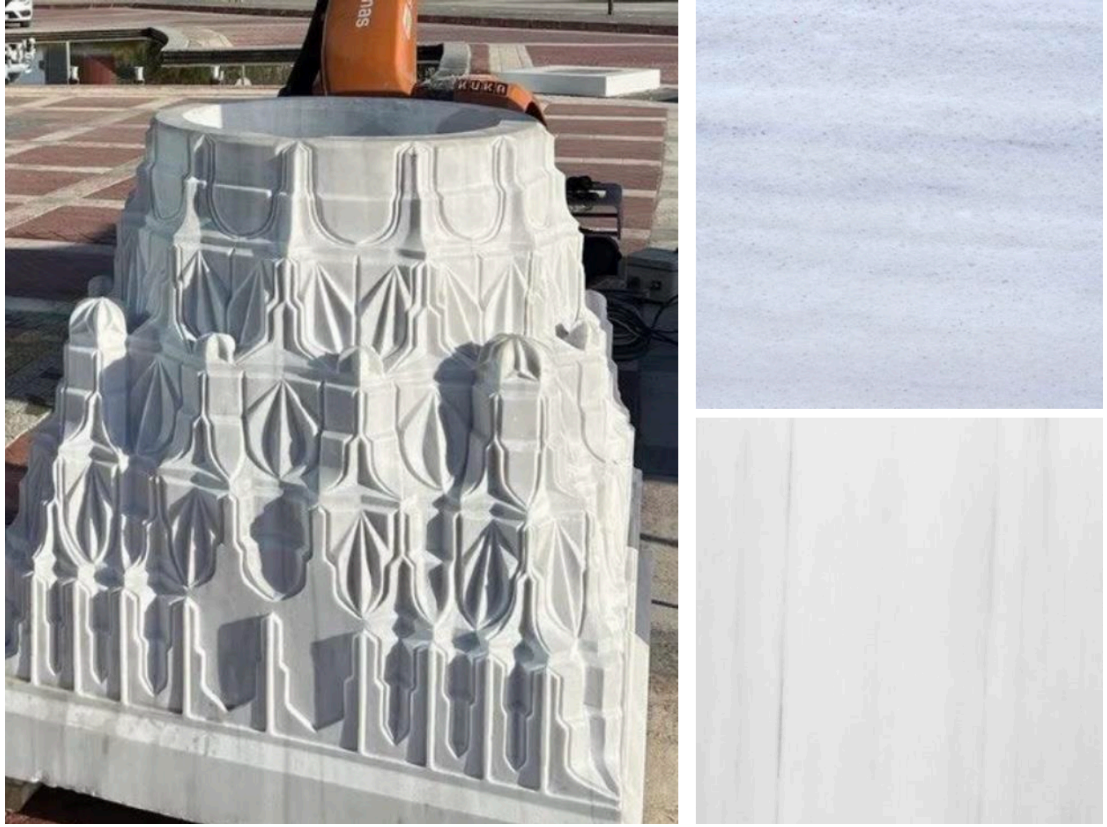
Şekil 4.2: Solda: Gürmal Gürel üretimi Marmara beyazı mukarnas; Sağ üst: Marmara beyazı mermer; Sağ alt: Beyaz dolomit.
