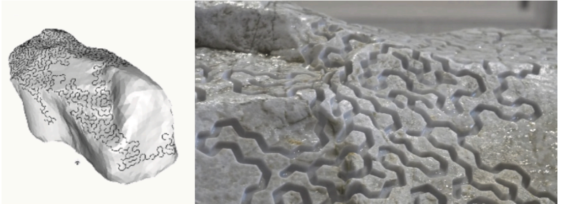
Şekil 3.9 : Taranarak yüzey geometrisi oluşturulan model(sol), işlenmiş malzeme(sağ) (Garcia del Castillo y Lopez, 2022).
