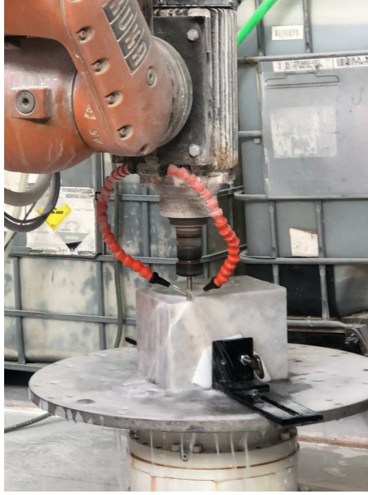
Şekil 3.5 : Döner tablaya sabitlenmiş mermer parçanın işlenmesi
