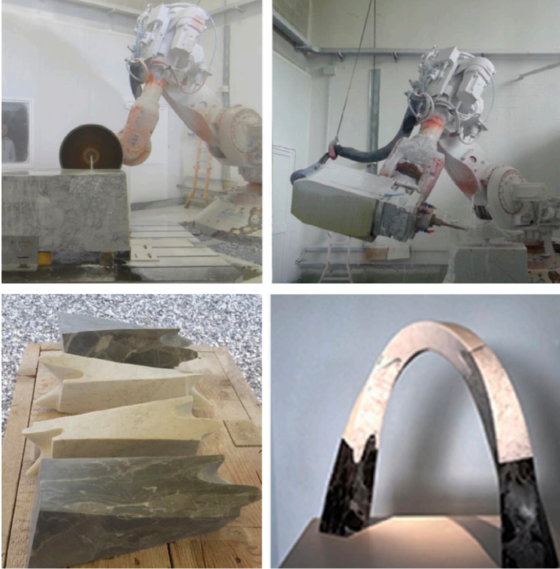
Şekil 3.7: Üst, 7 eksenli robot ile işleme süreci. Alt, işlenmiş parçalar ve prototip (Fernando ve diğ. 2019)
