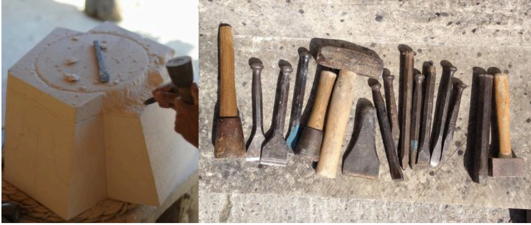
Şekil 3.3: Sol, taş yüzeyinde çizilen yol boyunca parçalar kopararak eksiltilmesi. (URL-23). Sağ, kaba işleme için kullanılan araçlar (URL-24).
