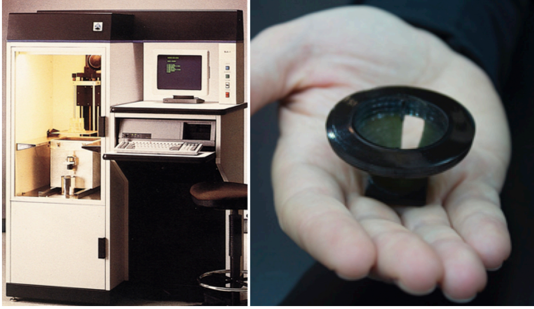
Şekil 2.4: Sol, ilk SLA 3boyutlu yazıcı teknolojisi (URL-15). Sağ, üretilen ilk parçalardan biri (URL-16).
