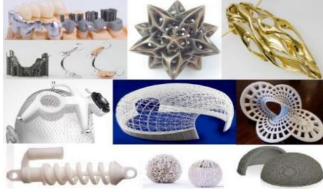
Şekil 2. 10: SLS ile üretilen parçalar [21]
