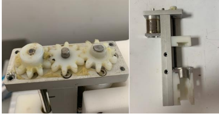
Şekil 3. 34: Şırınga sistemindeki dişliler ve şırınganın genel görünümü
