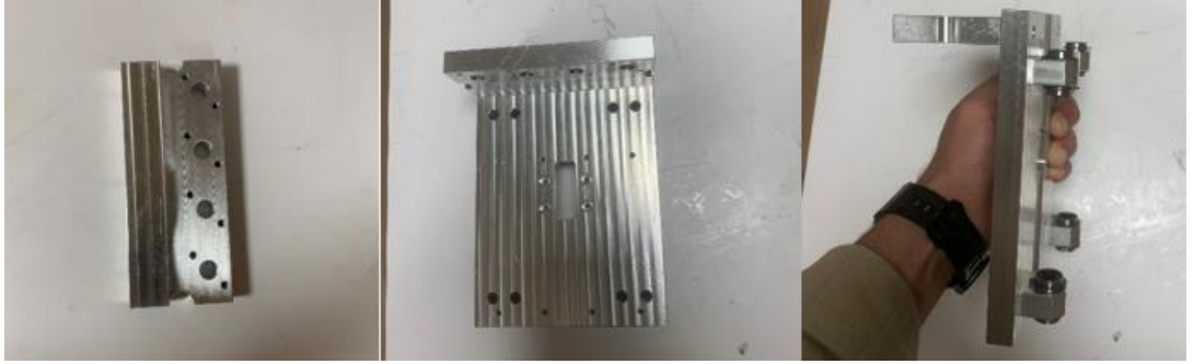
Şekil 3. 28: Şırınga taşıyıcıya destek parçasının montajı
