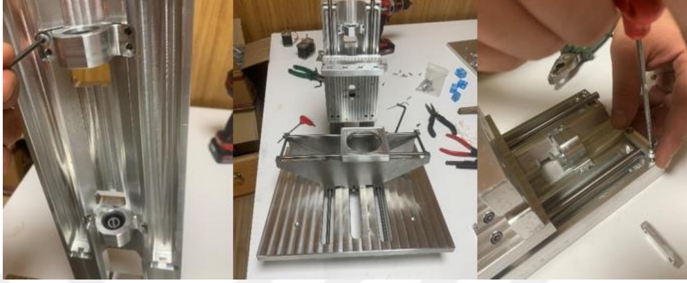
Şekil 3. 30: Şırınga taşıyıcının dikey yüzeye montajı
