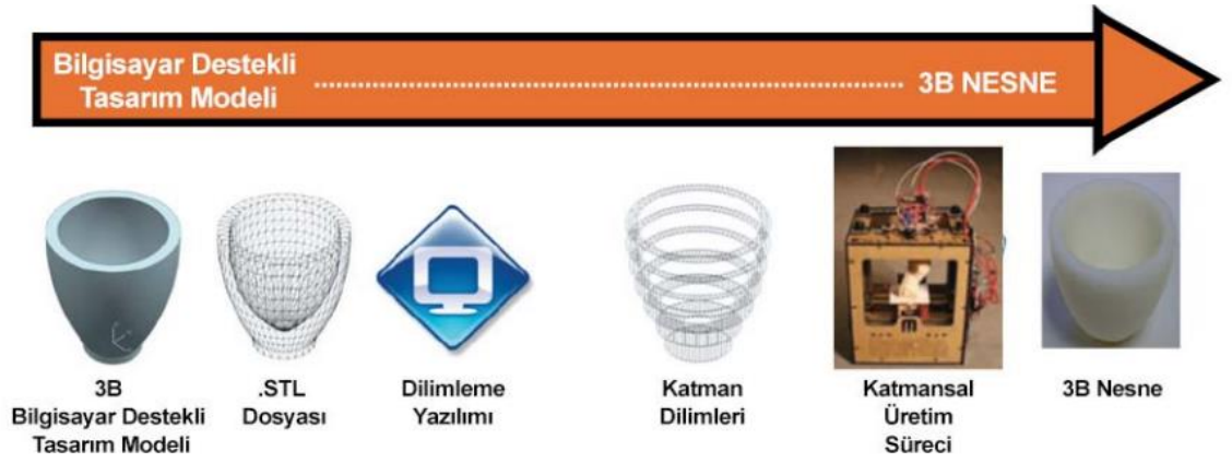
Şekil 2.1: 3B yazıcılarda katmansal üretim süreci [13]
