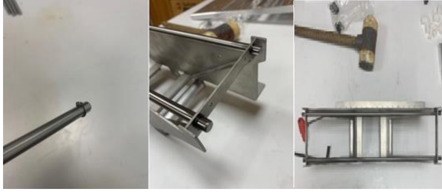
Şekil 3. 21: Düz millerin tabla taşıyıcıya montajı
