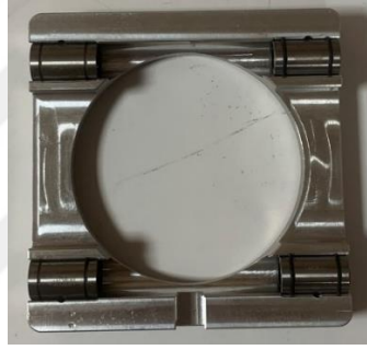
Şekil 3. 22: Tablaya rulmanların takılması
