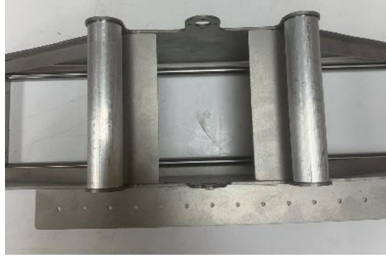
Şekil 3. 24: Düz millerin geçeceği boruların takılması
