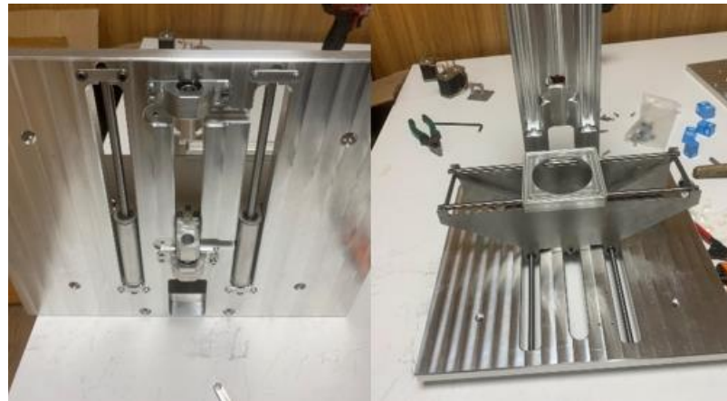
Şekil 3. 26: Tabla taşıyıcının yatay yüzeye montajı
