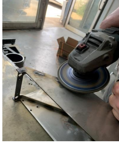
Şekil 3. 19: Tabla taşıyıcının taşlanma işlemi
