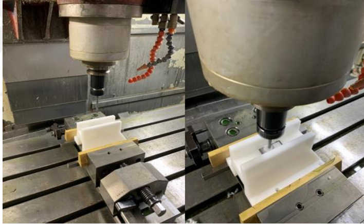
Şekil 3. 35: Delrin POM-C ara parçanın işlenmesi
