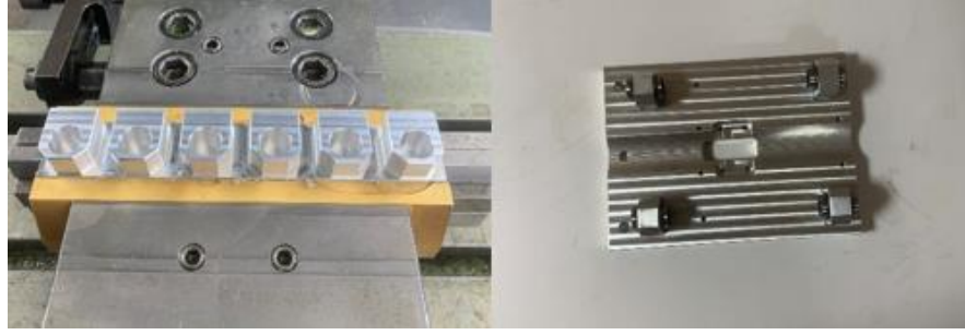
Şekil 3. 27: Şırınga taşıyıcıya rulmanların montajı
