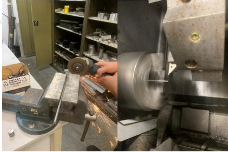
Şekil 3. 20: Düz millerin kesilme ve segman yuvası açılma işlemleri
