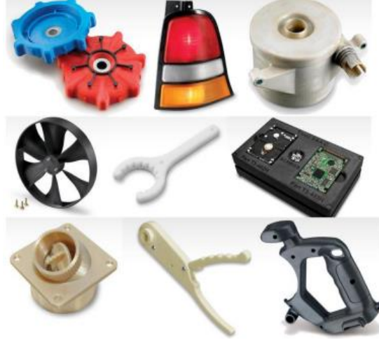
Şekil 2. 8: FDM yöntemi ile üretilmiş nesneler [21]
