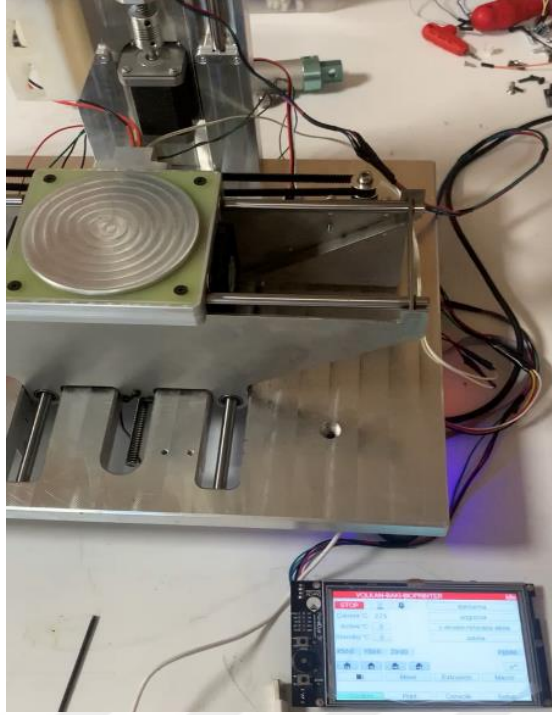
Şekil 3.48: Biyoyazıcı ile ekran panelinin test edilmesi
