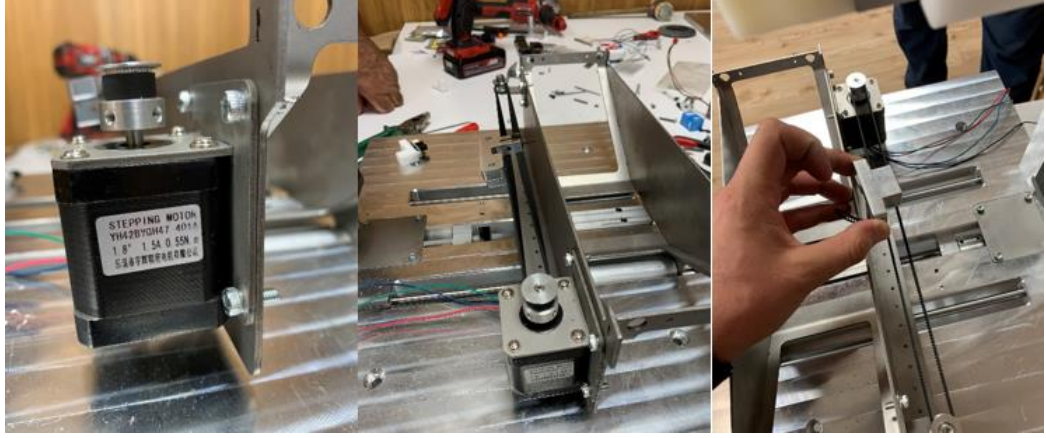
Şekil 3. 39: X ekseninde hareketi sağlayacak olan motor ve kayış-kasnak sistemi
