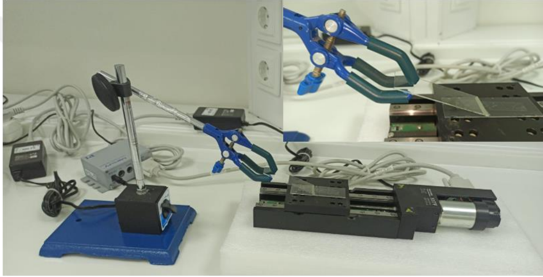
Şekil 3.2 İletim derleme cihazının fotoğrafı ve AgNPs-lateks karışımının cam slayt üzerinde yürütülme fotoğrafı.
