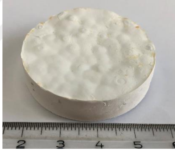
Şekil 4.5. İkinci tasarım doku iskelesinin 3°C/dakika ısıtma ve soğutma hızı ile 1250°C’de 2 saat sinterlendikten sonraki görüntüsü
