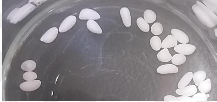
Şekil 4.1. Mekanik karıştırıcı kullanılarak hazırlanan çamurla sol-jel yöntemiyle şekillendirilen seramik-aljinat kompozit küreler
