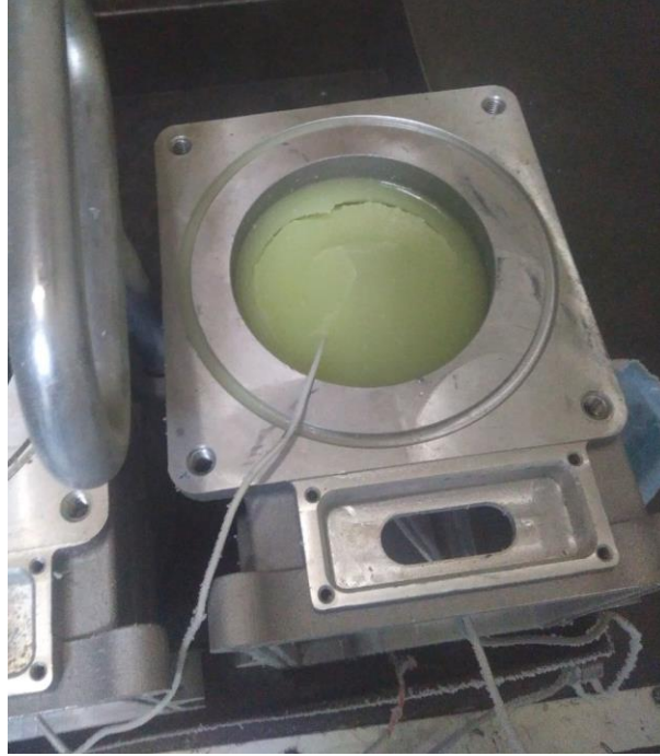
Şekil 5.20 Soğuk oda testlerinde hal değişimi görülen dizel yakıt
