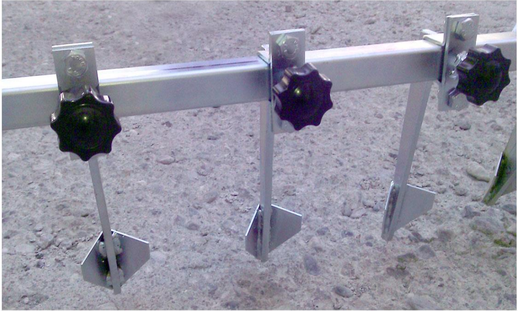
Resim 3: Denemede sıraları oluşturmak için kullanılan el markörü.
