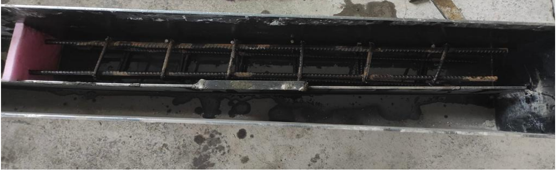
Şekil 3.26: Geopolimer kiriş içerisinde kullanılan donatı
