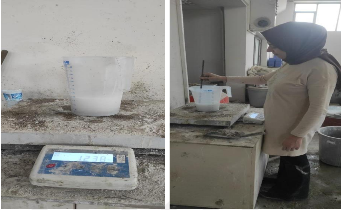
Şekil 3.16: NaOH Çözeltisinin (Alkali aktivatör) Hazırlanması
