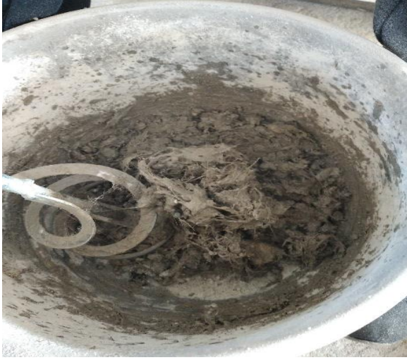
ğ: katı karışımların sodyumhidroksit ile karışımı
