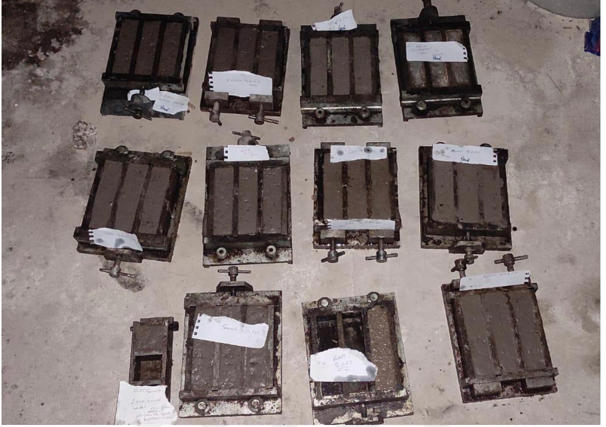
Şekil 3.18: Döküm sonunda kalıplara yerleştirilen geopolimer beton
