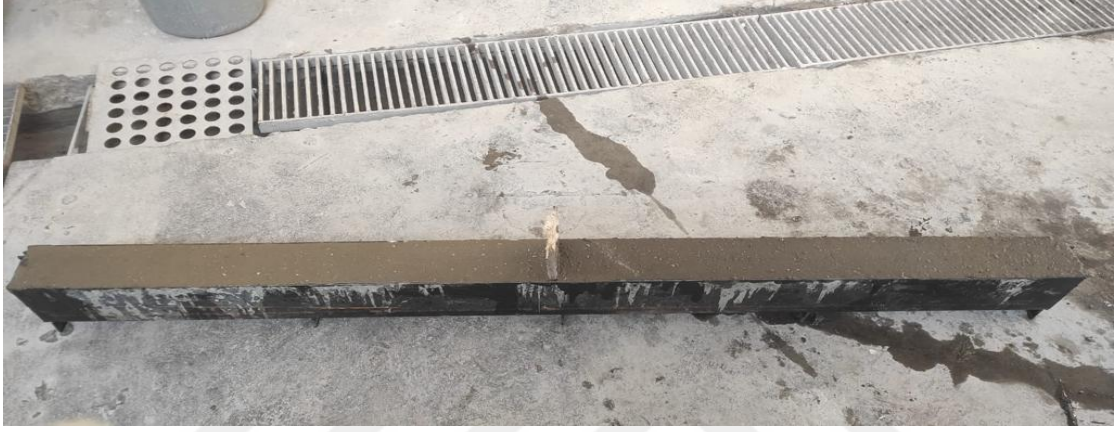
Şekil 3.27: Kalıplara yerleştirilen geopolimer beton
