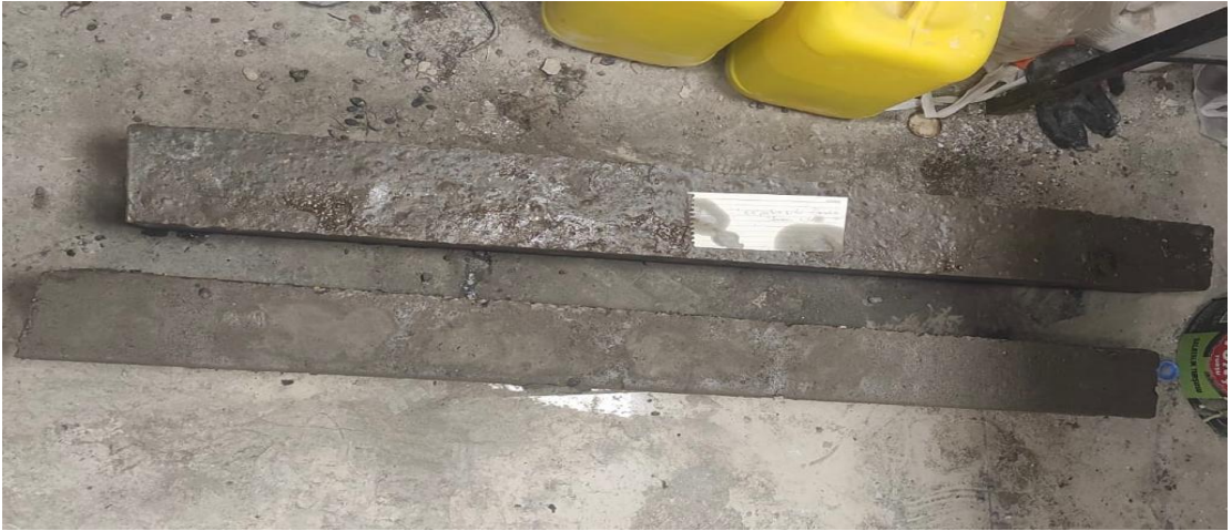
Şekil 3.27: Kalıplara yerleştirilen geopolimer beton
