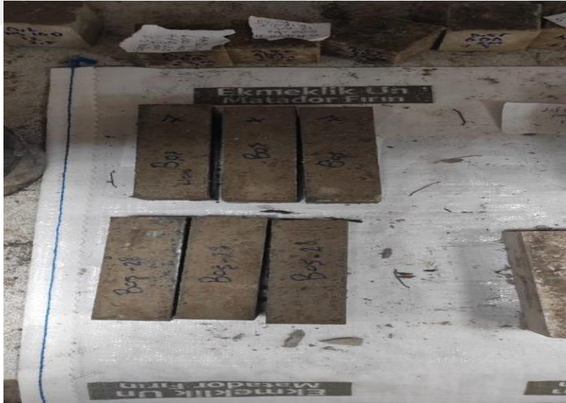
Şekil 3.19: Kalıptan çıkartılan geopolimer beton
