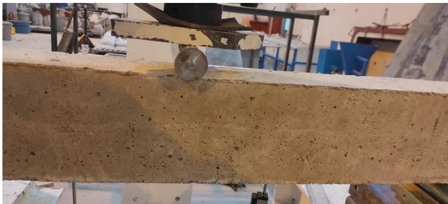
Şekil 3.23: Yükleme yapılacak kısmına kauçuk ve çelik dairesel plaka yerleştirme görseli
