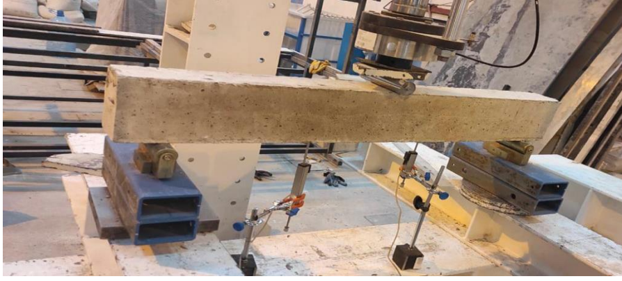
Şekil 3.24: LVDT yerleştirilmiş yüklemeye hazır geopolimer kiriş
