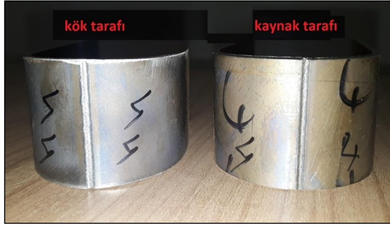
Şekil 7.27 Eğme testi sonrası 4. numuneye ait görsel
