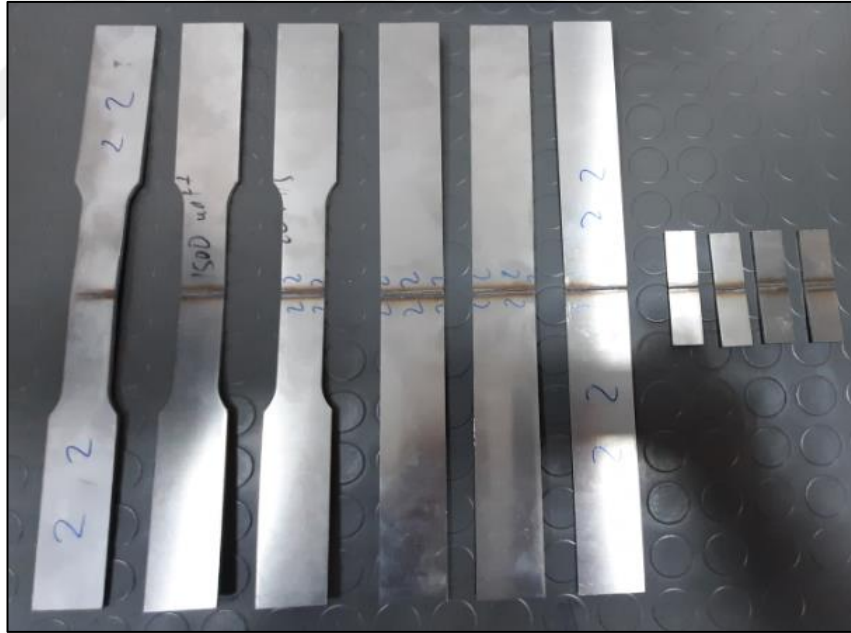
Şekil 6.10 Bir plakadan kesilen tüm inceleme numuneleri
