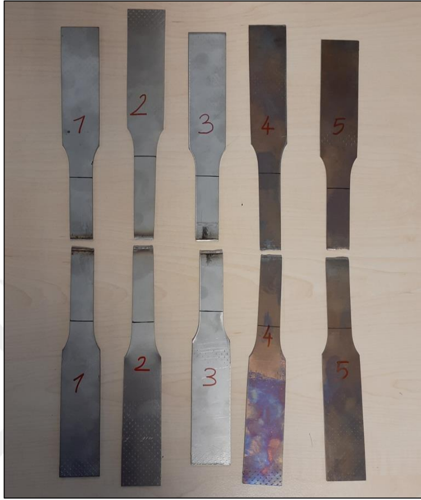
Şekil 7.17 Çekme testi sonrası numuneler
