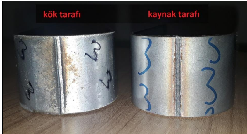
Şekil 7.26 Eğme testi sonrası 3. numuneye ait görsel
