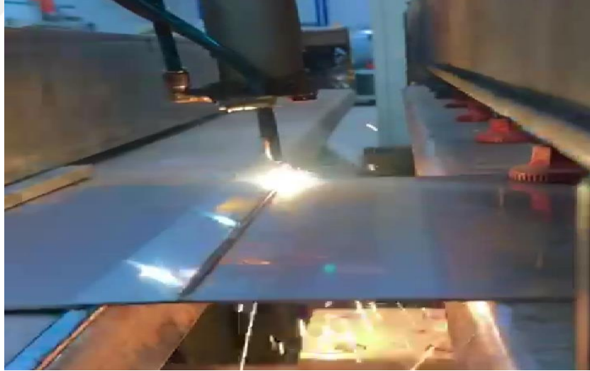
Şekil 6.3 Nd:YAG lazer kaynak işlemleri sırasında numunelerin sabitlendiği fikstür
