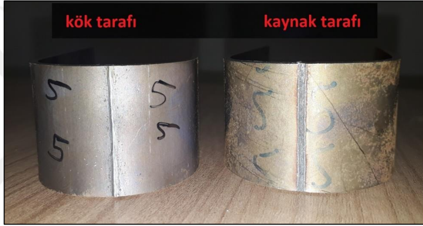
Şekil 7.28 Eğme testi sonrası 5. numuneye ait görsel
