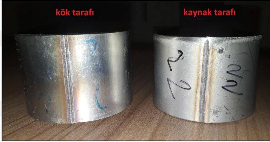
Şekil 7.25 Eğme testi sonrası 2. numuneye ait görsel
