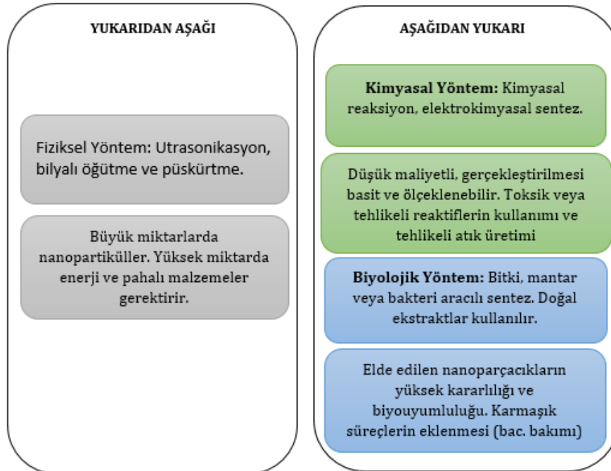
Şekil 5:Nanopartikül sentez yönteminde Top Down ve Bottom Up yöntemleri (Bruna, 2021)
