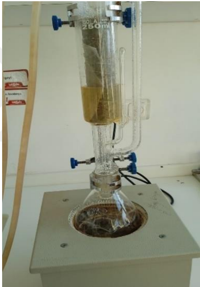
Resim 14: Hazırlanan örnekler, filtre kağıdına sarılarak sokslet cihazında ekstrakte edilmesi.
