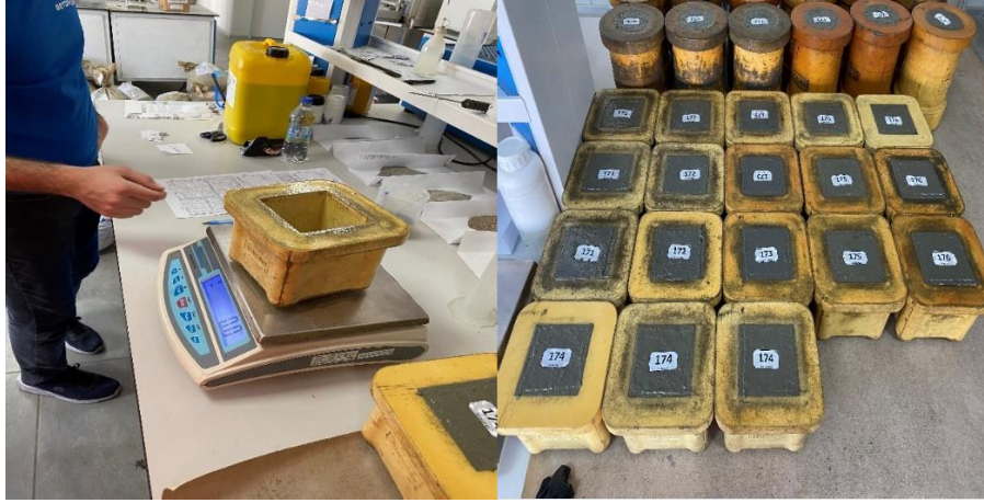
Şekil 4.11 Kalıpların daralarının alınması ve yoğunluk tayini
