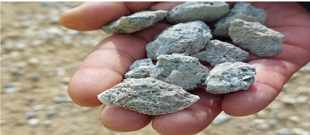
Şekil 4.6 Konkasör makina işlemi ardında oluşan GKA
