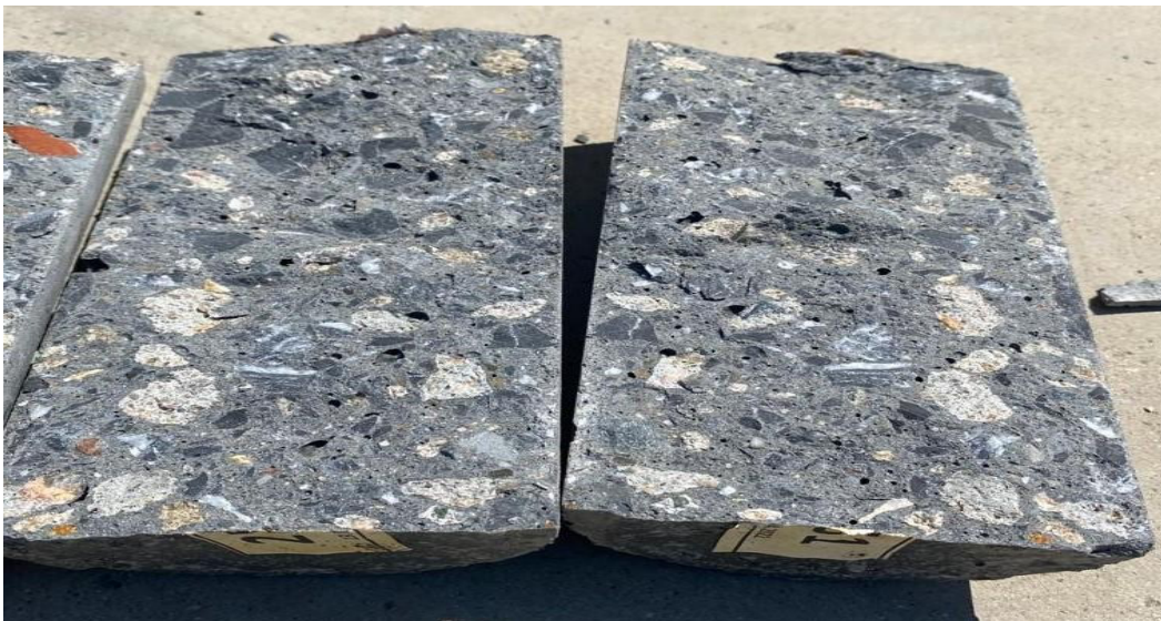
Şekil 4.14 Yarmada çekme deneyleri sonucu numune yüzeyleri
