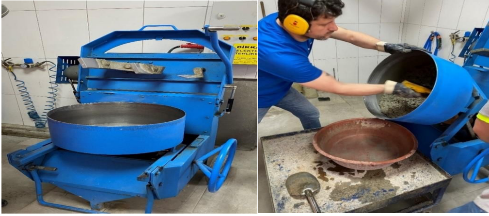
Şekil 4.9 Cebri karıştırıcılı betoniyer
