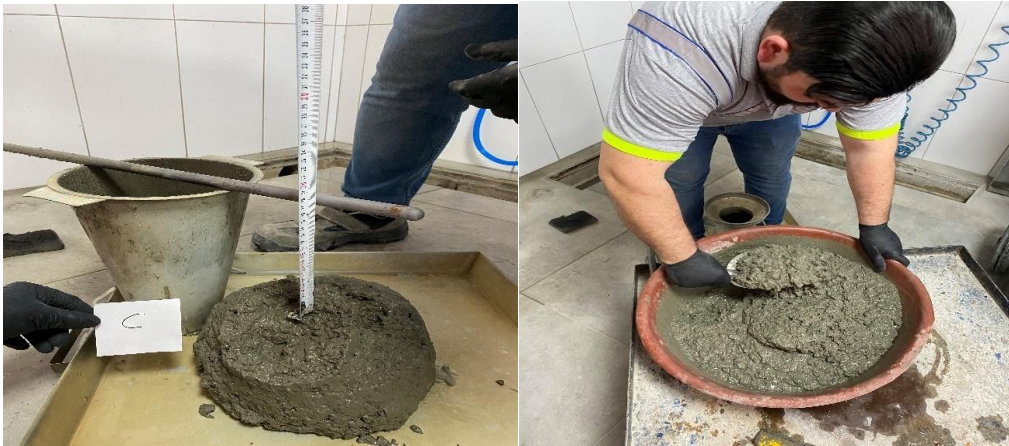
Şekil 4.10 Taze beton çökme deneyleri
