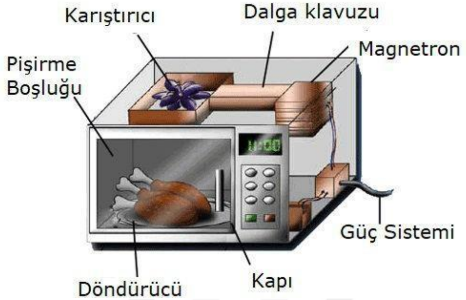
Şekil 2.6. Mikrodalga fırını oluşturan bölümler (Anonim, 2023c)
