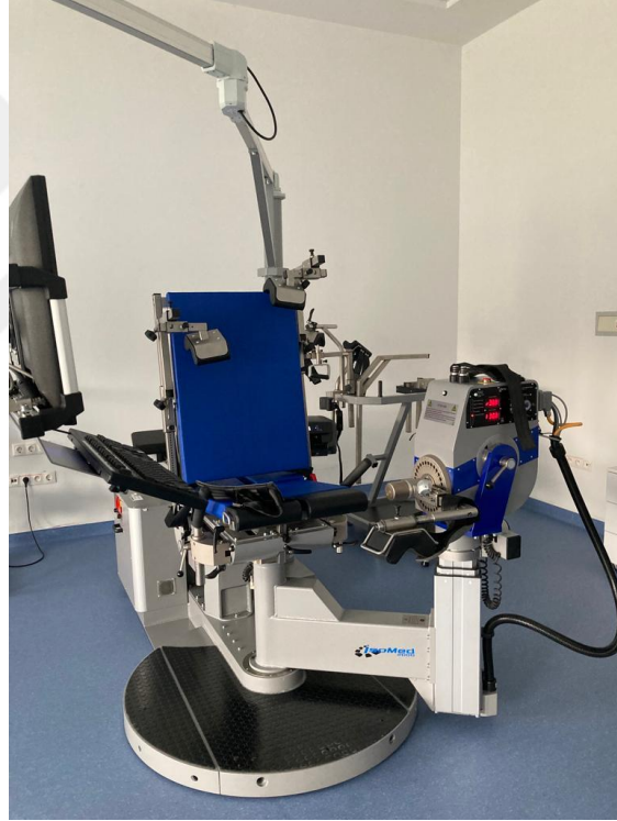
Şekil 2.3. Isomed 2000 Basic: İzokinetik sistem.
