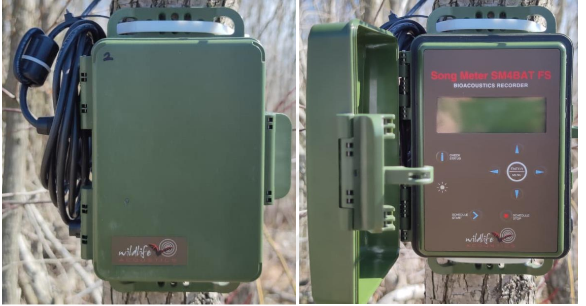
Şekil 3.6 Wildlife Acoustics Song Meter SM4BAT FS ve SMM-U2 ultrasonik mikrofon
