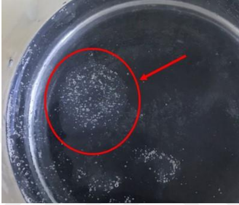
Şekil 4.6. Altıgenin Jelatin destek banyosu v0 ile basıldıktan sonra CaCl 2 içindeki görünümü
