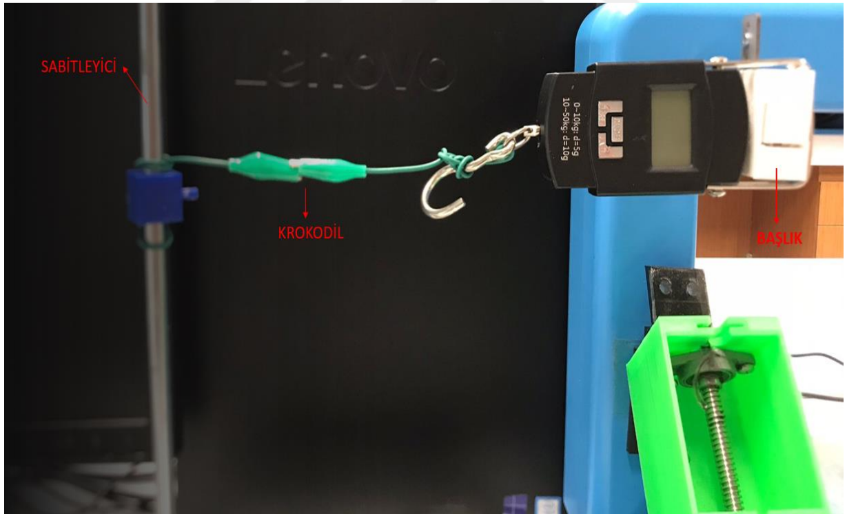
Şekil 3.19. Çekme testi için kurulan düzenek
