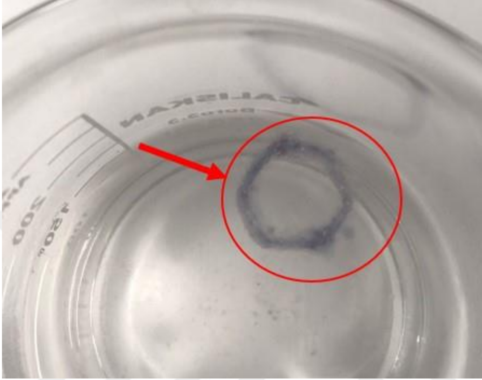
Şekil 4.8. Altıgenin jelatin destek banyosu v1 ile basıldıktan sonra \text{CaCl}_2 içindeki görünümü
