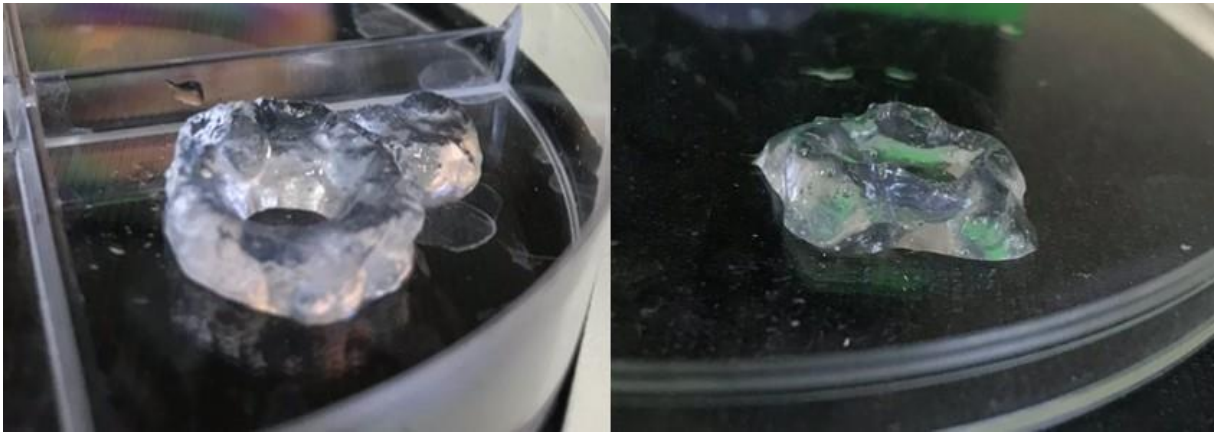
Şekil 4.7. Jelatin destek banyosu v0 ile basılan altıgenin çapraz bağlanma işleminden sonraki görünümü
