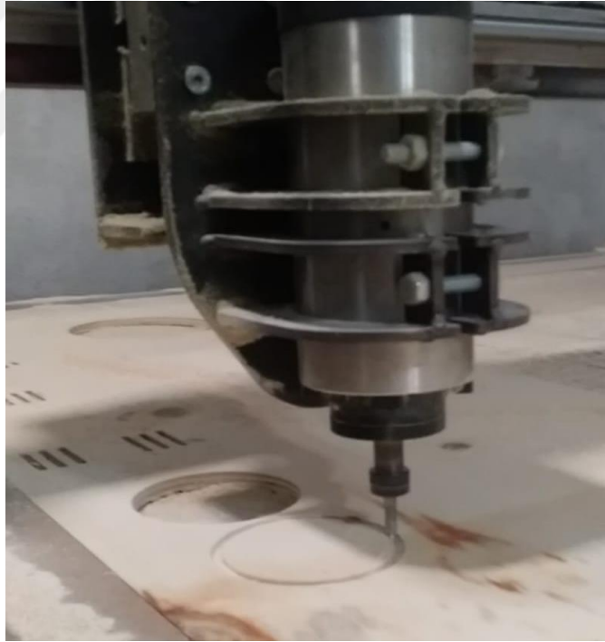
Şekil 3.9. Ahşap Oyuncak Mutfak Seti CNC Kesim Aşaması
