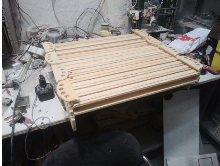
Şekil 3.5. Ahşap Oyuncak Mutfak Seti Ön Çita Cila Aşaması ve kalite konrtölü
