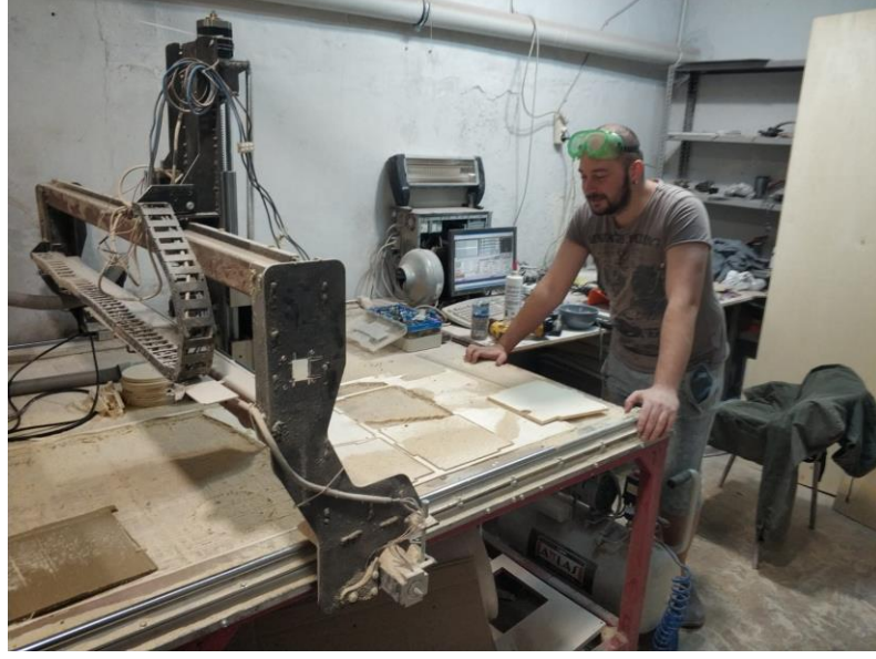
Şekil 3.3. Ahşap Oyuncak Mutfak Seti CNC Üretim Aşaması
