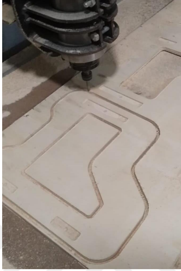
Şekil 3.18. Ahşap Oyuncak Kitaplık Seti CNC Kesim Aşaması.
