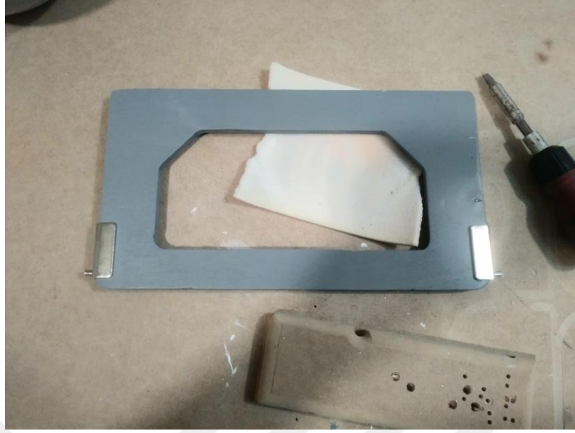
Şekil 3.8. Ahşap Oyuncak Mutfak Seti Ocak Kapağı Mentеше Montaj Aşaması
