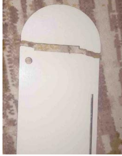
Şekil 4.3. Kırık Ahşap Oyuncak Mutfak Seti
