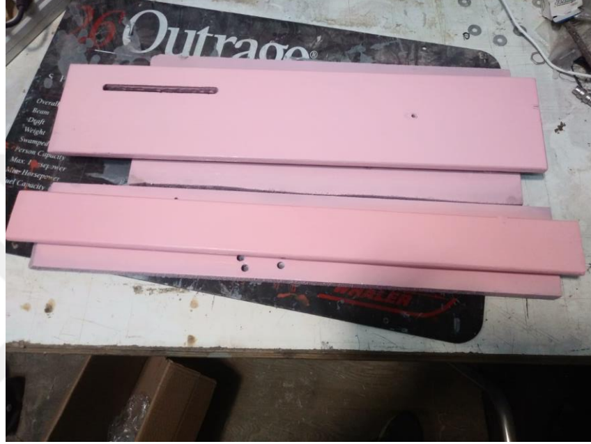
Şekil 3.7. Ahşap Oyuncak Mutfak Seti Su Bazlı Boya İle Boyama Aşaması ve kalite kontrolü
