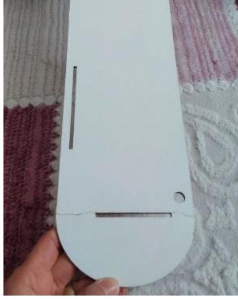
Şekil 4.5. Yapısal Bütünlüğü Bozulan Ahşap Oyuncak Mutfak Seti
