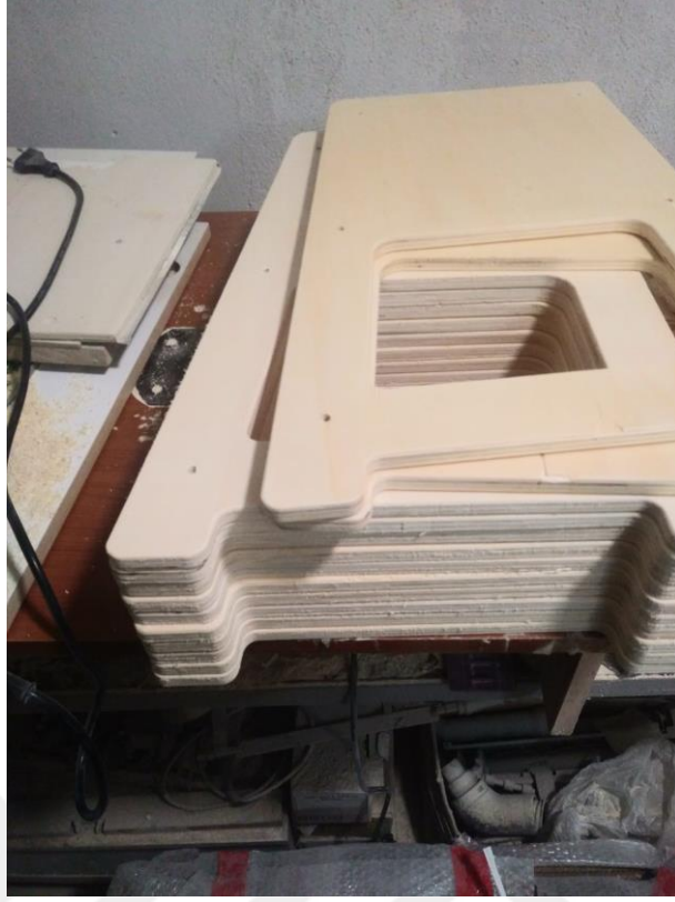
Şekil 3.4. Ahşap Oyuncak Mutfak Seti Kenar Freze Aşaması
