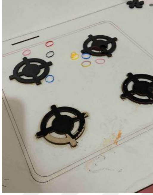
Şekil 4.4. Boyası Çıkmış Ahşap Oyuncak Mutfak Seti
