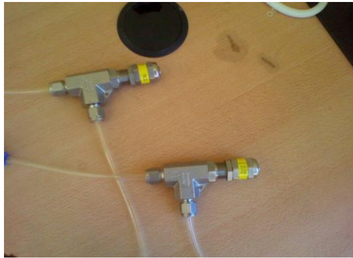
Şekil 4.10: Deney düzeneğindeki basınç emniyet valflerinden bi
