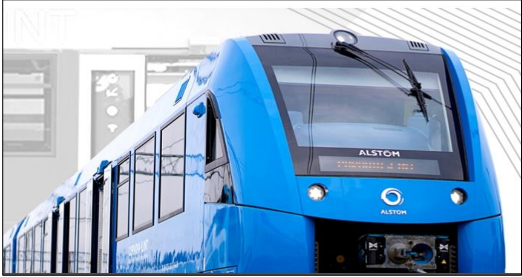
Şekil 2.8: Alstom şirketi tarafından yapılmış, yakıt hücreleri ise Cummins tarafından geliştirilen Coradia iLint isimli tren.
