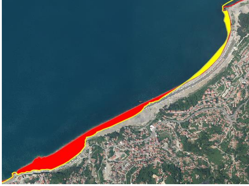
Şekil 5.38 2022 Yılı Ortofoto Üzerinde Kilimli Yolu Dolgu Ve Kıyı Erozyon Alanları (Kırmızı: Dolgu, Sarı: Erozyon)
