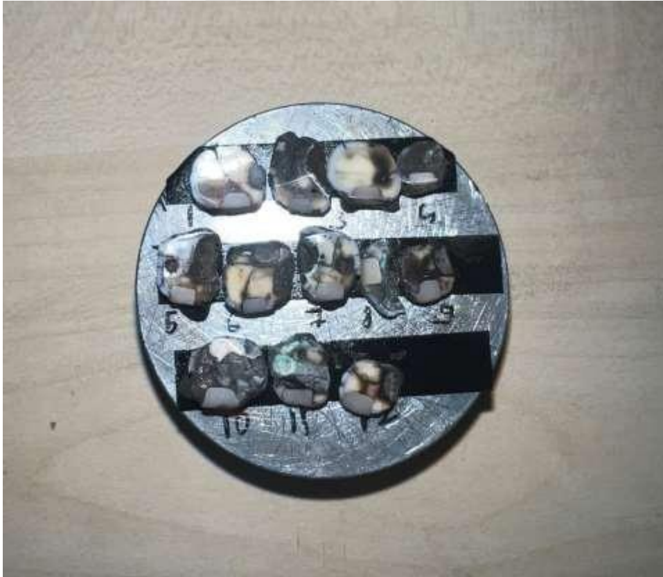
Resim 3.9. Alüminyum numune tutucuya karbon bant yardımıyla yapıştırılan diş örnekleri.
