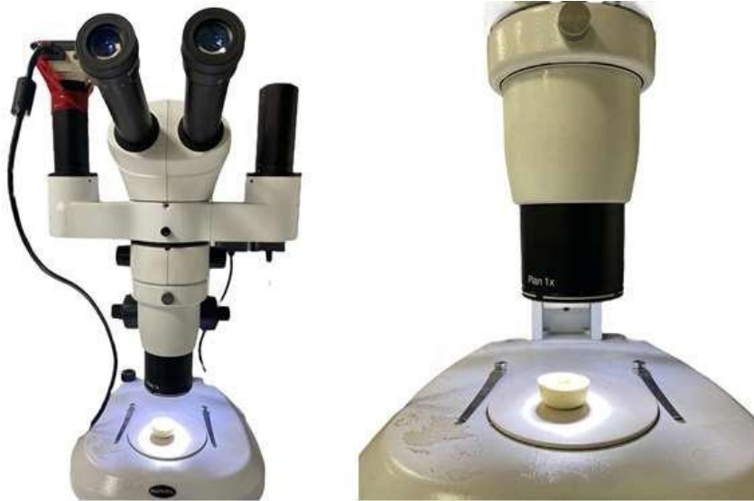
Resim 3.15. Kırılma tiplerinin incelenmesi için çalışmada kullanılan stereomikroskop (Novel, Industrial Estate, Ambala, Haryana, Hindistan) ve örneklerin incelenmesi.
