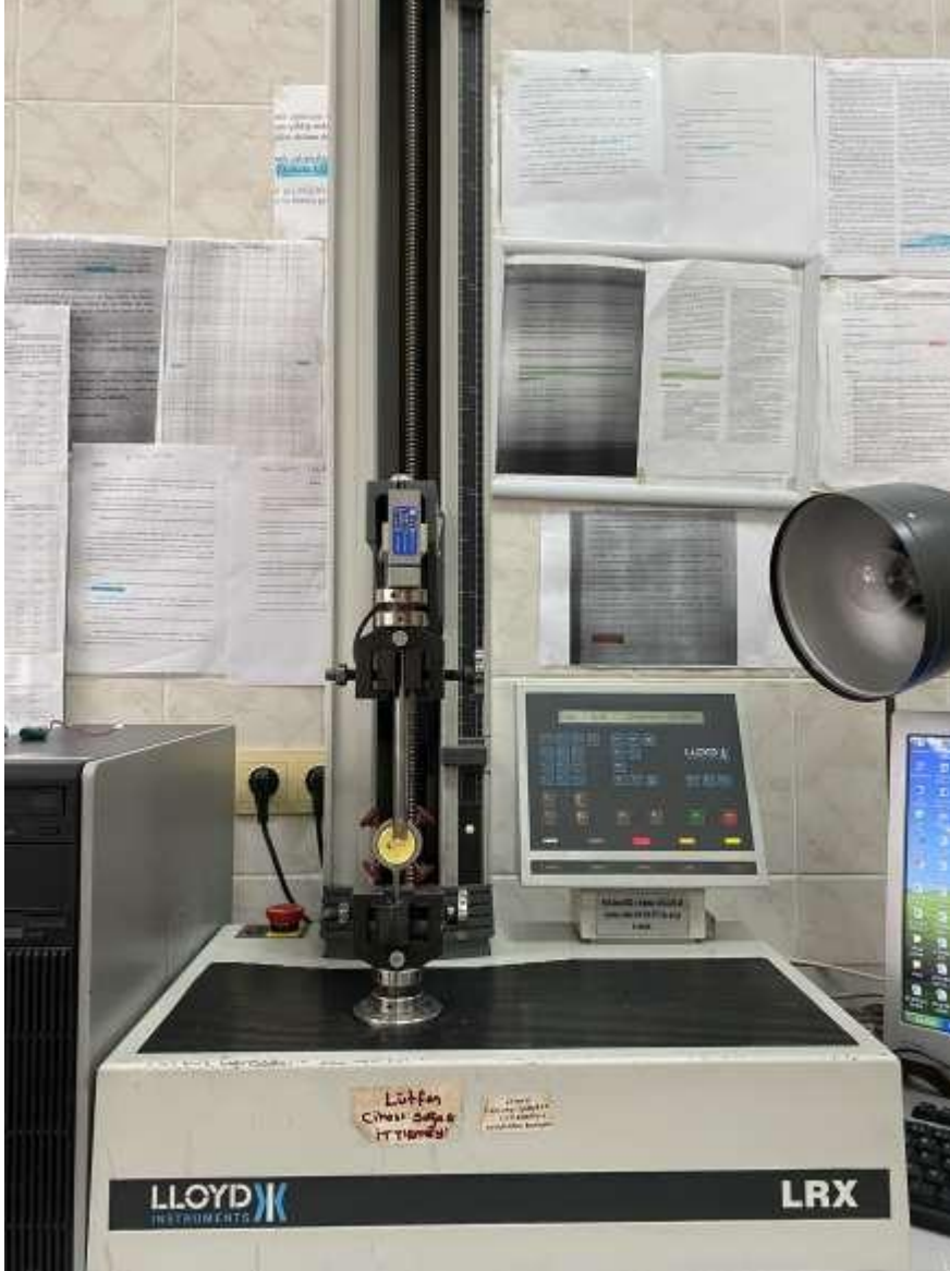
Resim 3.13. Makaslama bağlanma dayanımı (SBS) testi için kullanılan universal test cihazı (Lloyd-LRX, Lloyd Instruments, Fareham, İngiltere).
