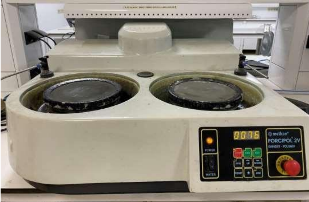
Resim 3.3. Forcipol 2V Grinder & Polisher (Metkon, Maidstone, İngiltere) aşındırma cihazı.
