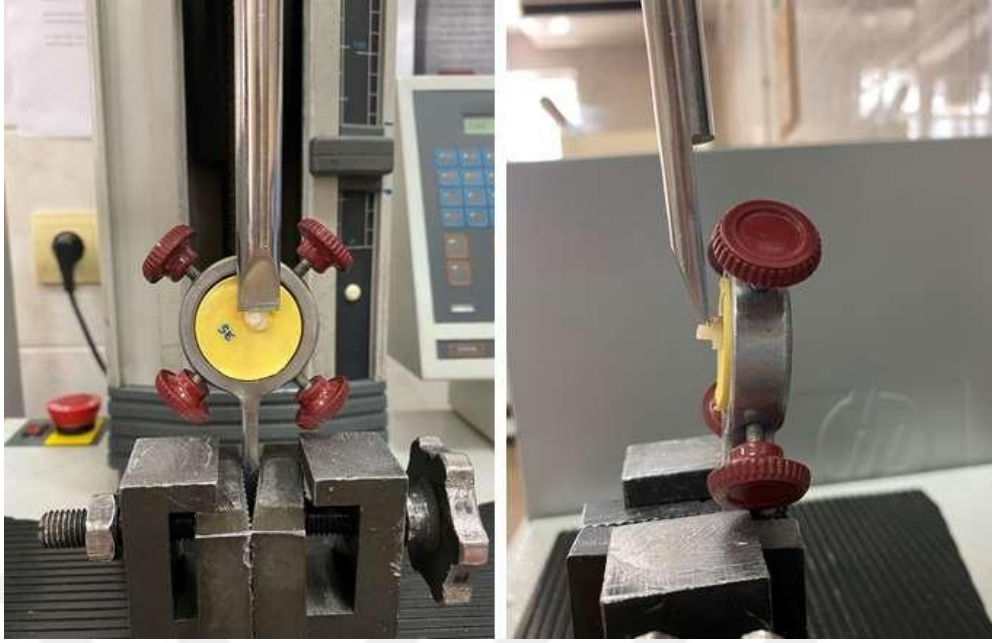
Resim 3.14. Makaslama bağlanma dayanımı için universal test cihazına yerleştirilen numune.
