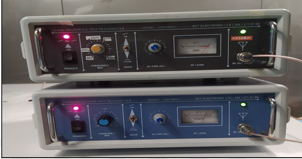
Resim 3.2. EMA kaynağı olarak kullanılan jeneratörler
