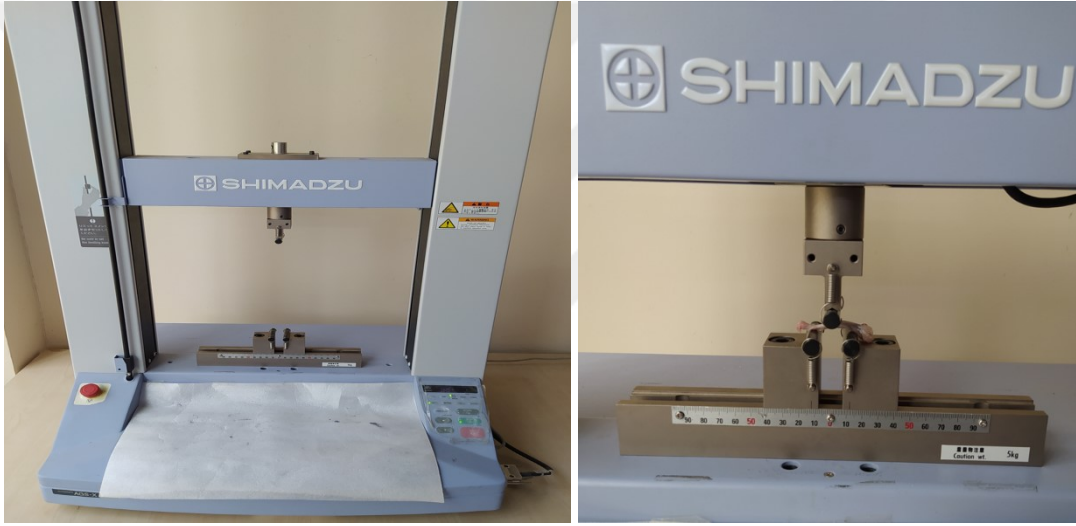
Resim 3.12. Kemik biyomekanik özelliklerini belirlemek için kullanılan cihaz
