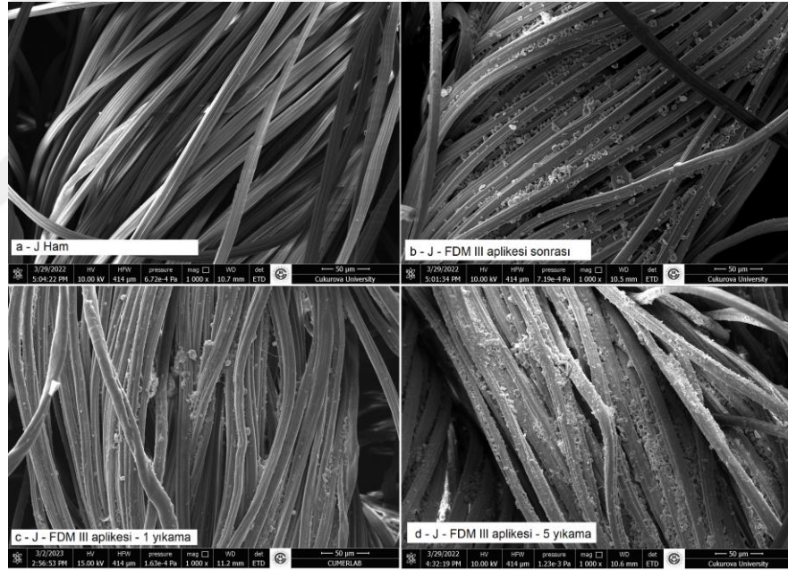
Şekil 4.36. J Kodlu - Ne 12 - %100 Bambu Kumaşın Ham(a), FDM III applike edilmiş(b), 1 yıkama(c) ve 5 yıkama(d) sonrası durumlarına ait SEM görüntüleri
