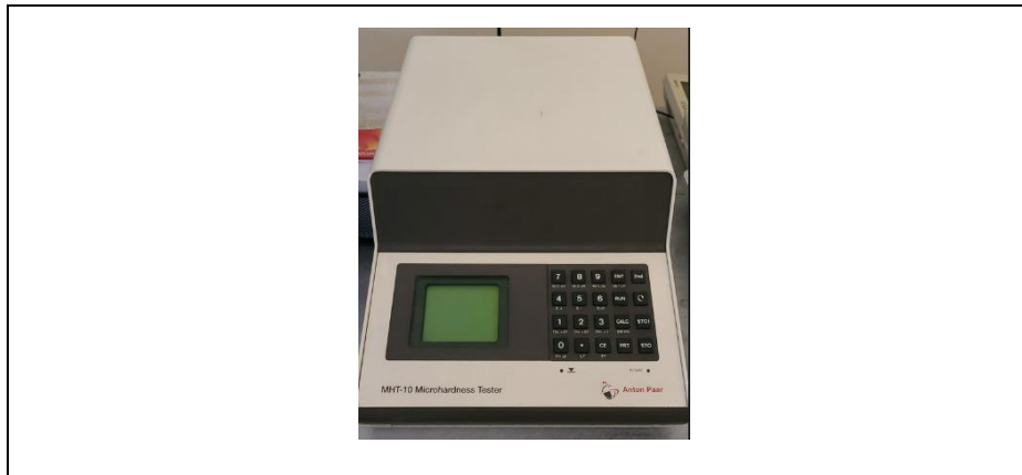
Şekil 3.5: Yeniden kristallenme tavlamaları yapılan numunelerin mikro sertlik ölçümlerinde kullanılan sertlik cihazı.
