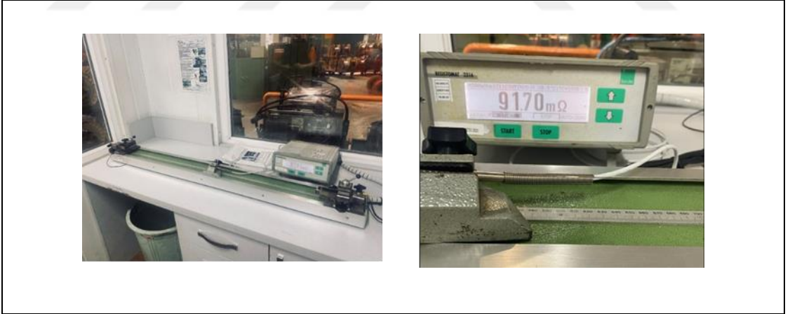
Şekil 3.7: Yeniden kristalleşme tavlamaları yapılan numunelerin elektriksel direnç ölçümlerinde kullanılan miliohm metre.
