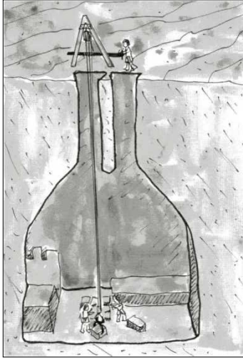
Şekil 2.3. Taşın Taş Ocaklarından Temini (Dikey Yönde Yapılan Çalışma) (Cevahir, 2019: 23)
