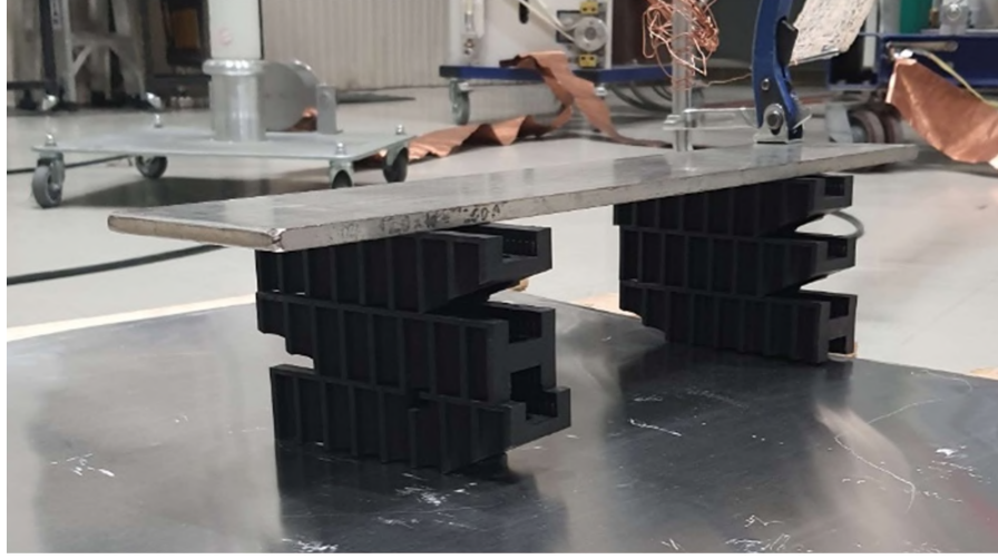
Şekil 7.9: Üç leplast takoz ile yapılan deney düzeneği.
