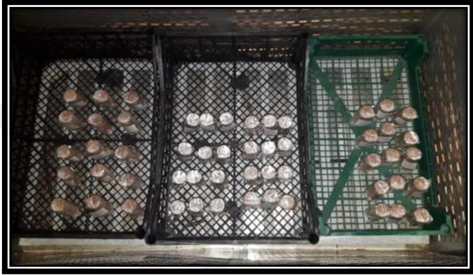
Şekil 35. Hazırlanan numunelerin donma çözölme kabinine yerleştirilmesi
