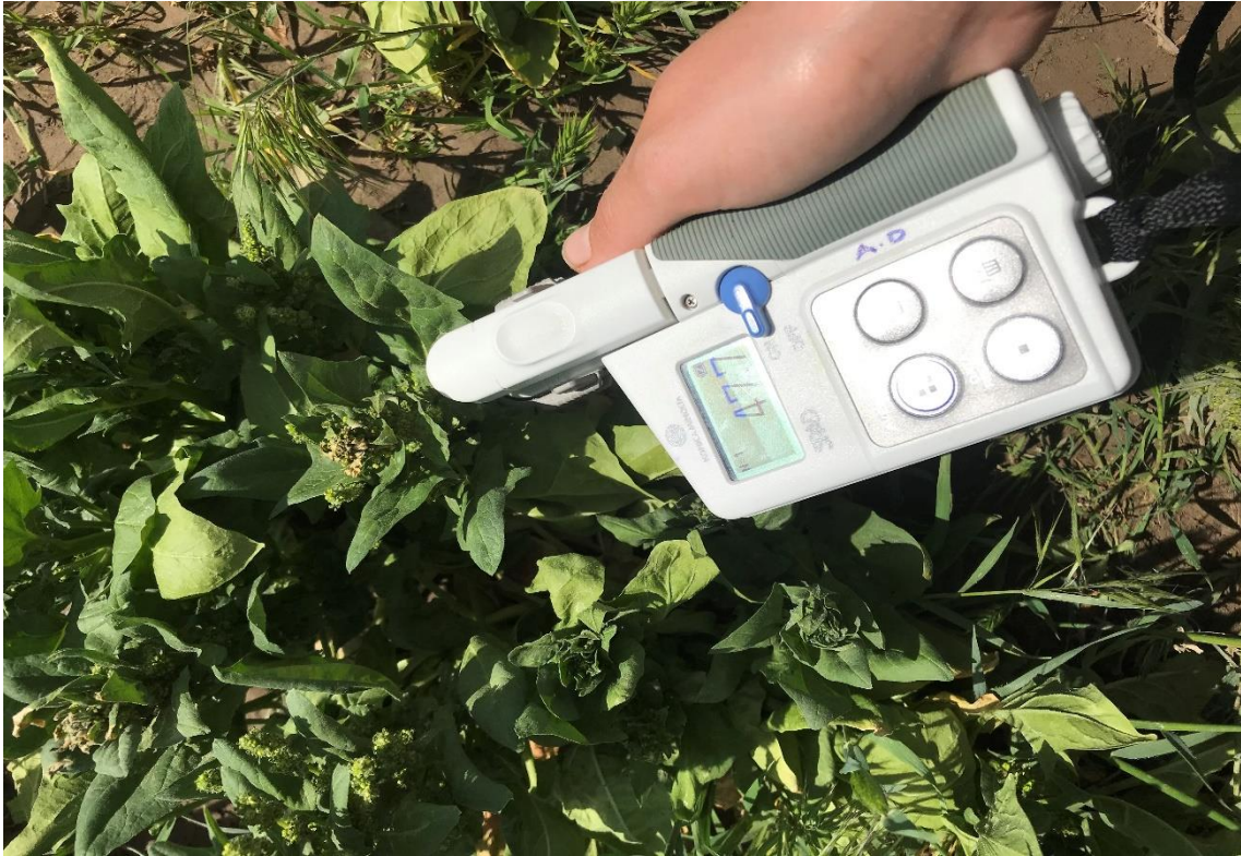
Şekil 3.11. Klorofil değerinin belirlenmesi.
