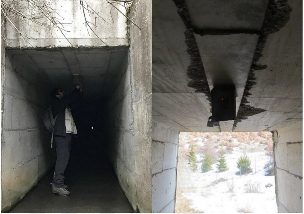
Şekil 3.6 Menfez altına fotokapan kurulumu (Foto: Deniz Özüt)
