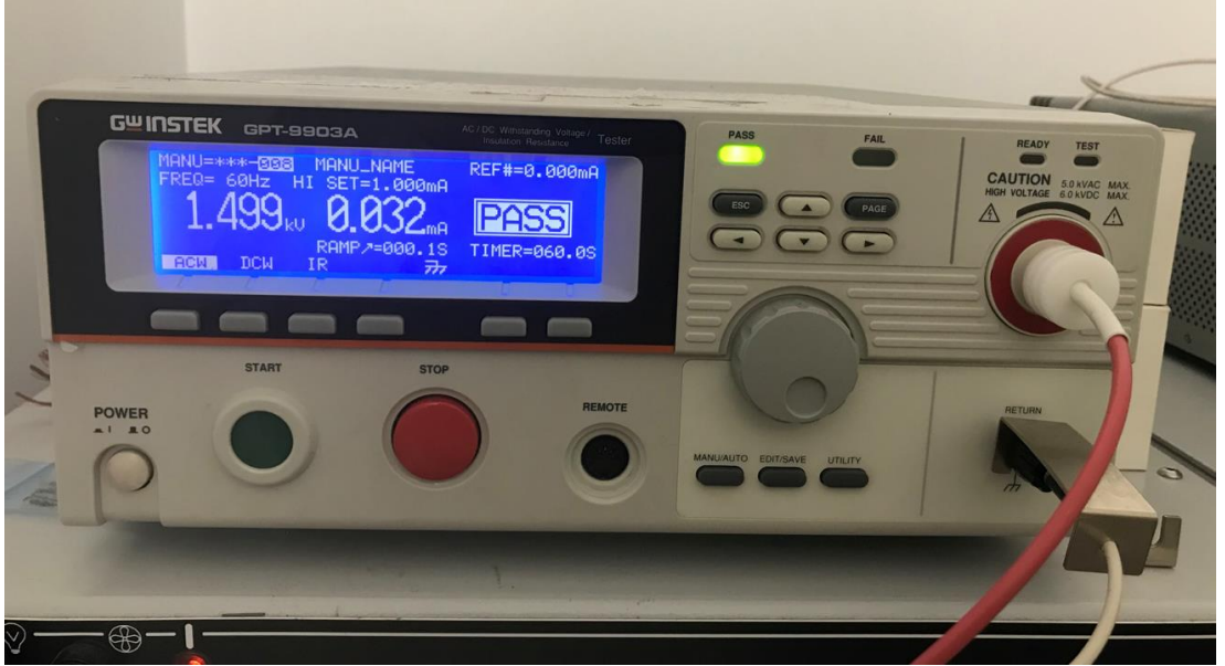
Şekil 4.41: Ürünün 1500V izolasyon testinden geçtiğini belirten görsel
