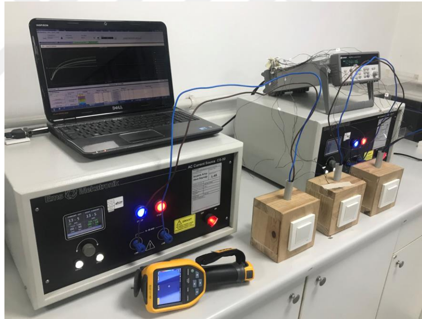
Şekil 4.13: Aşırı akım testi uygulanan anahtar ürünlerinin test ve ölçüm düzeneği
