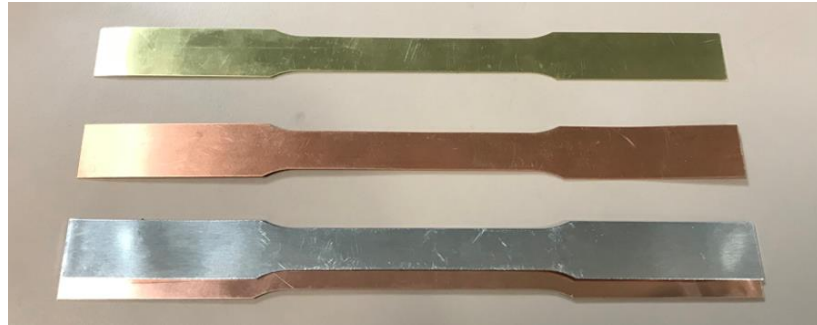
Şekil 4.1: Çekme testi için hazırlanmış papyon ham madde numuneleri
