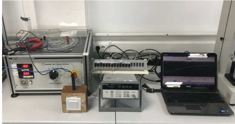
Şekil 4.29: Ömür testi sonrasında yapılan sıcaklık artışı test düzeneği
