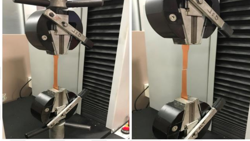
Şekil 4.6: Bakır papyon numuneye uygulanan çekme testi görselleri
