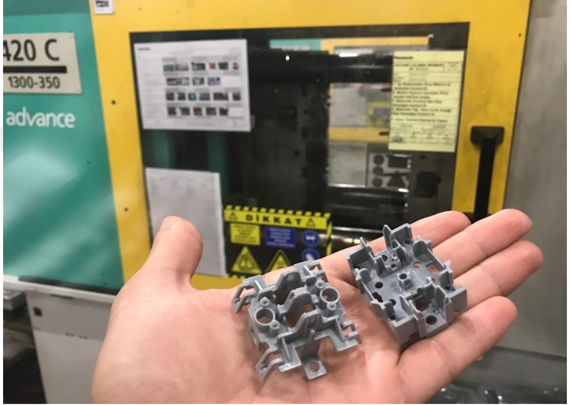
řekil 2.26: Polikarbonat (PC) ham madde kullanılarak alınan plastik kalıp baskı numuneleri
