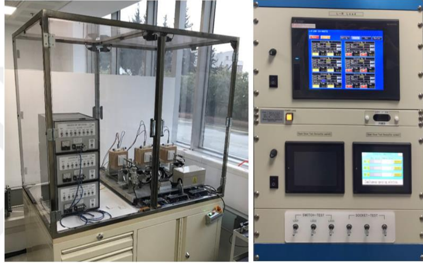
Şekil 4.22: Elektrik anahtarı ömür test cihazı ve ayar-takip ekranı
