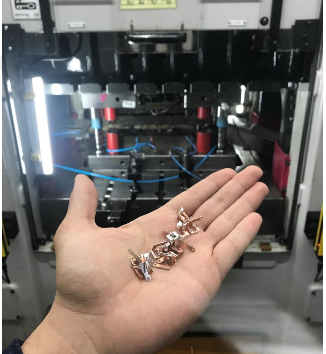
Şekil 2.25: Bimetelik levha kullanılarak alınan metal kalıp baskı numuneleri
