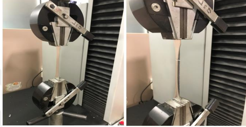
Şekil 4.2: Al-Cu papyon numuneye uygulanan çekme testi görselleri
