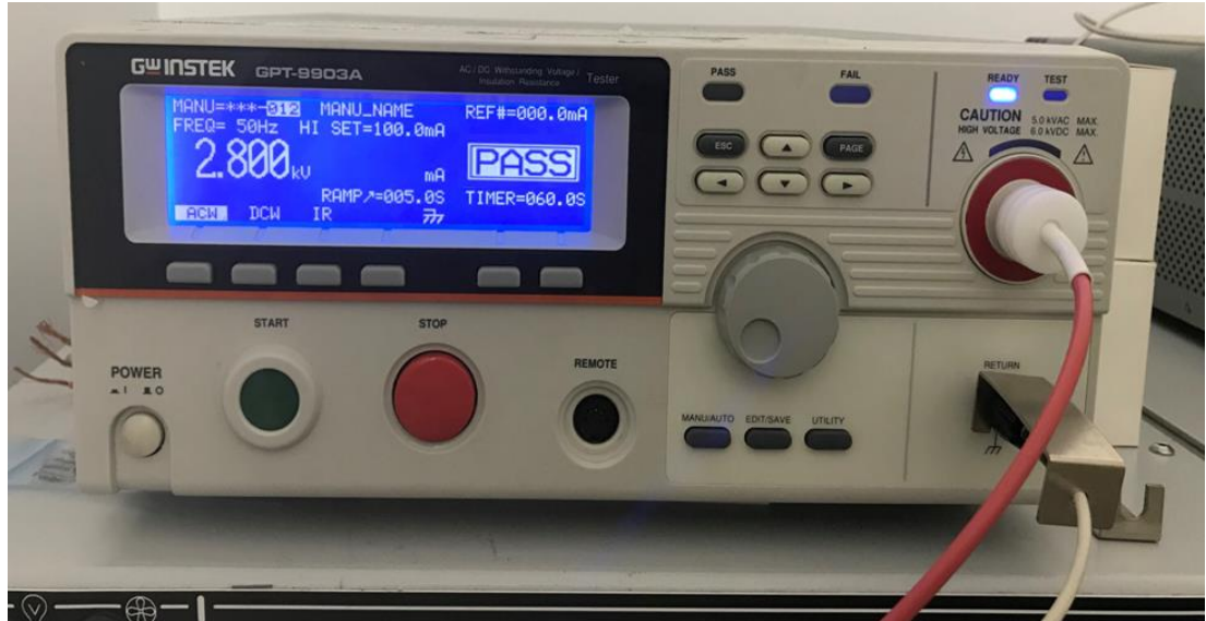
Şekil 4.43: Ürünün 2800V izolasyon testinden geçtiğini belirten görsel
