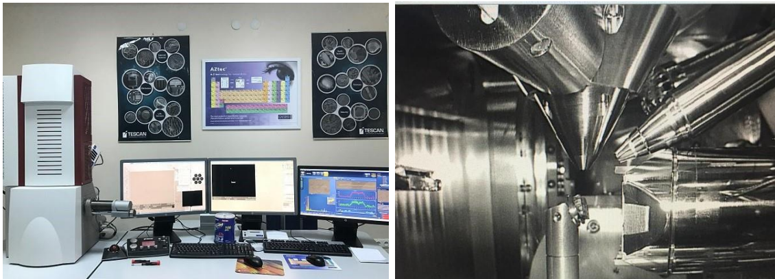
Şekil 4.15. EBSD analizi; a) SEM laboratuvarı, b) Oxford Nordlys dedektörü.
