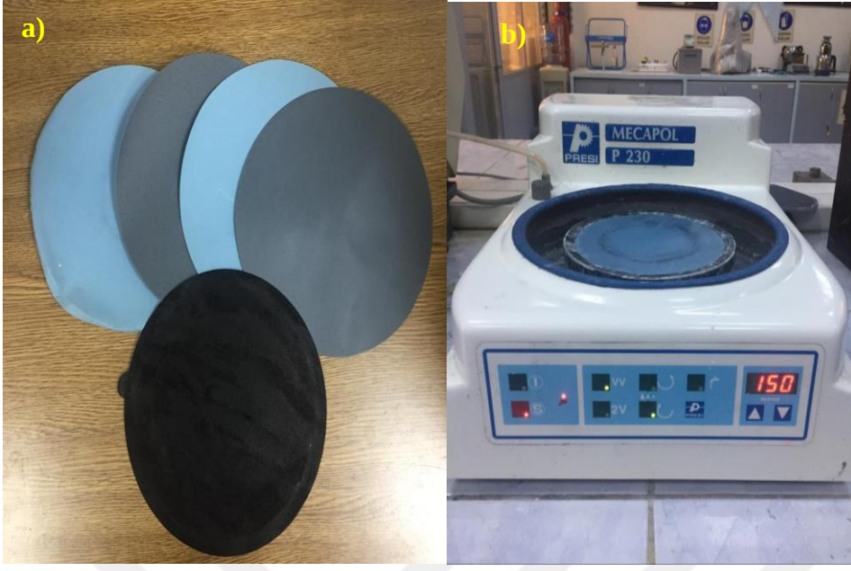
Şekil 4.11. Numune hazırlama; a) Zımpara ve parlatma diskleri, b) Zımparalama ve parlatma cihazı.
