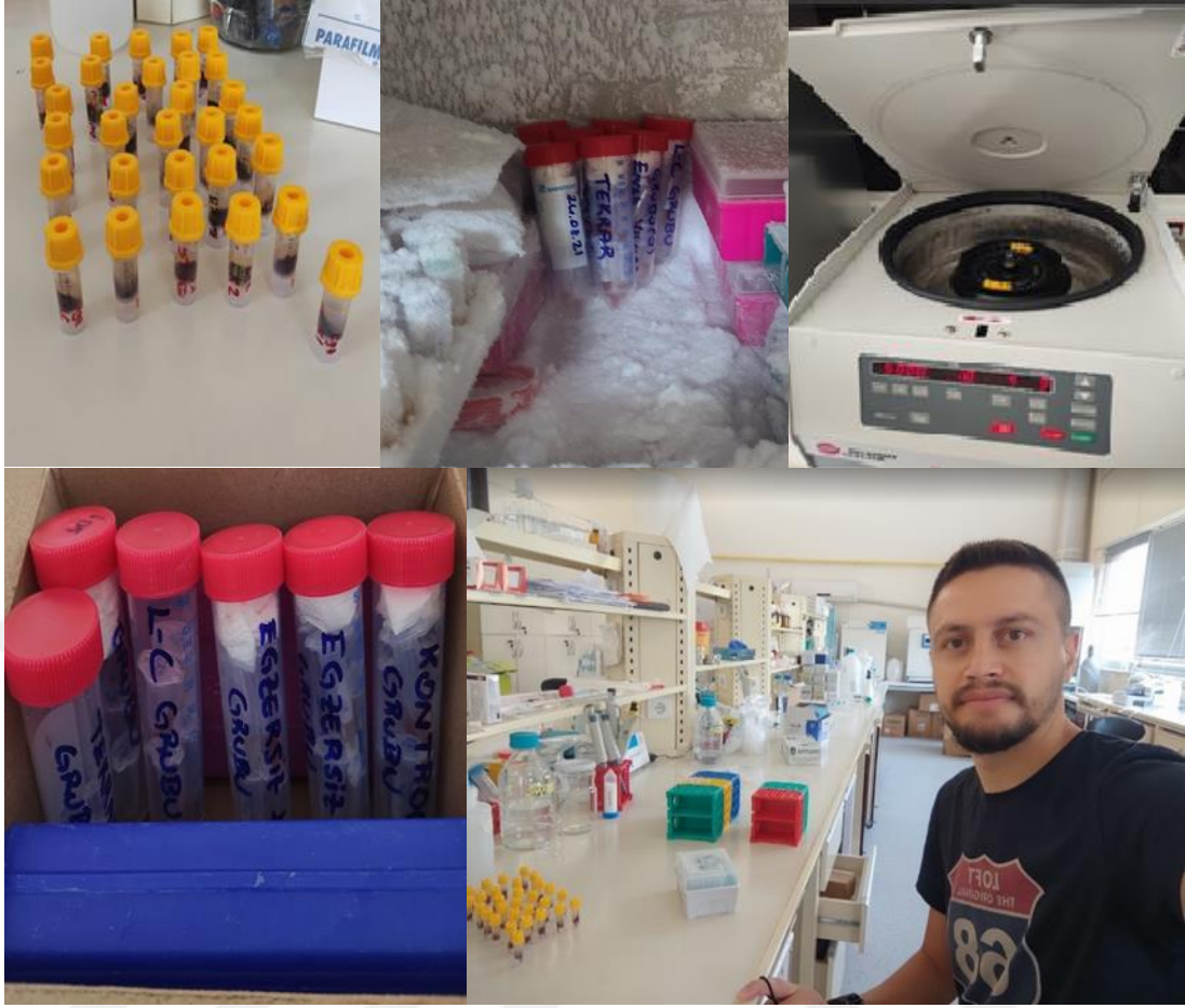
Şekil 5. Tüm rat gruplarından kan alımı sonrası kan örneklerinin santrifüj edilerek plazmasının ayrıştırılması
