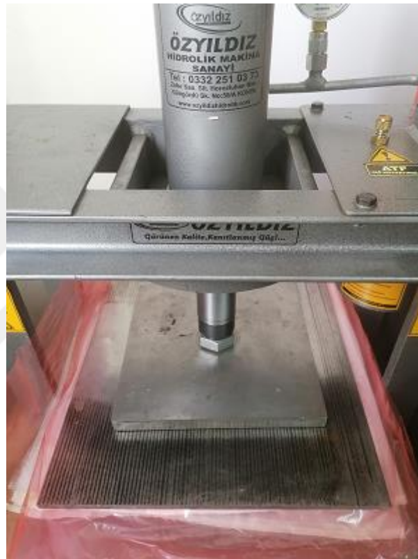
Şekil 3.1 Sıcak pres yöntemi ile E-Cam/Alüminyum kompozit sandviçlerin üretimi
