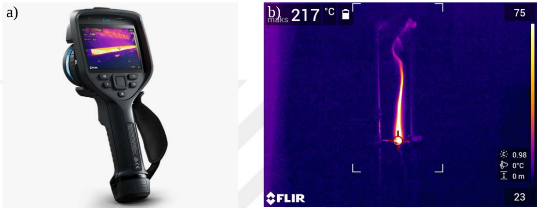
Şekil 3.11. Termal kamera (a) ve elde edilen alev görüntüsü (b)
