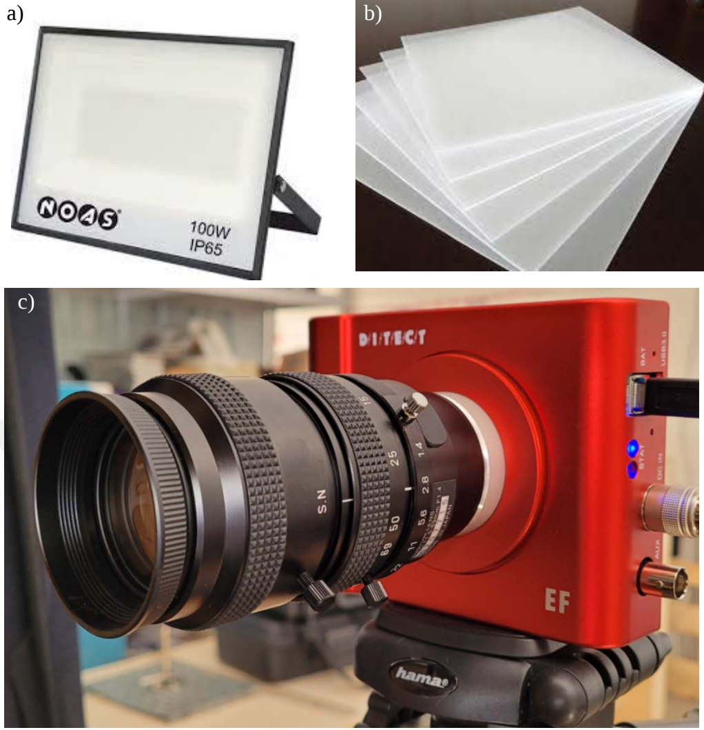
Şekil 3.8. Görüntüleme sistemi ana bileşenleri. (a) 100W LED aydınlatma, (b) Işık difüzörü, (c) Yüksek hızlı kamera ve objektif
