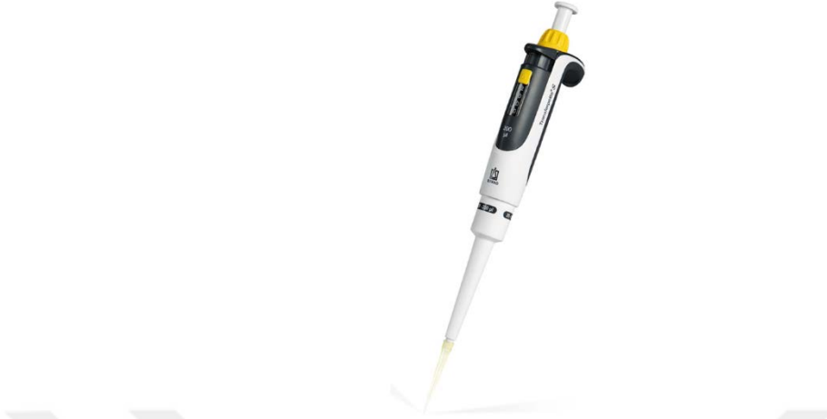
Şekil 3.5. Damlacık oluşturmak için kullanılan mikro pipet
