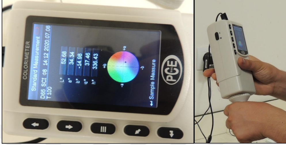
Fotoğraf 3.12 PCE-CSM marka kolorimetre cihazı ve renk lümü
