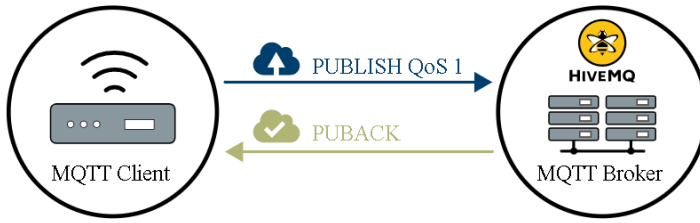
Şekil 3.6: MQTT QoS 1 (Anonim, 2015).
