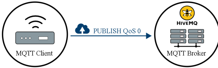
Şekil 3.5: MQTT QoS 0 (Anonim, 2015).
