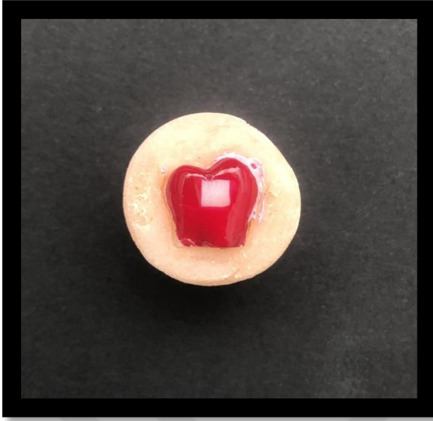
Resim 3.16. Mine yüzeyinin 3x3 mm 2 'lik alanı açıkta kalacak şekilde tırnak cilası ile kaplanmış görüntüsü
