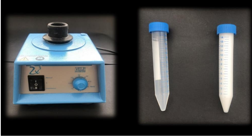
Resim 3.13. Karıştırıcı ve tüp içerisinde homojenize edilen macun solüsyonu
