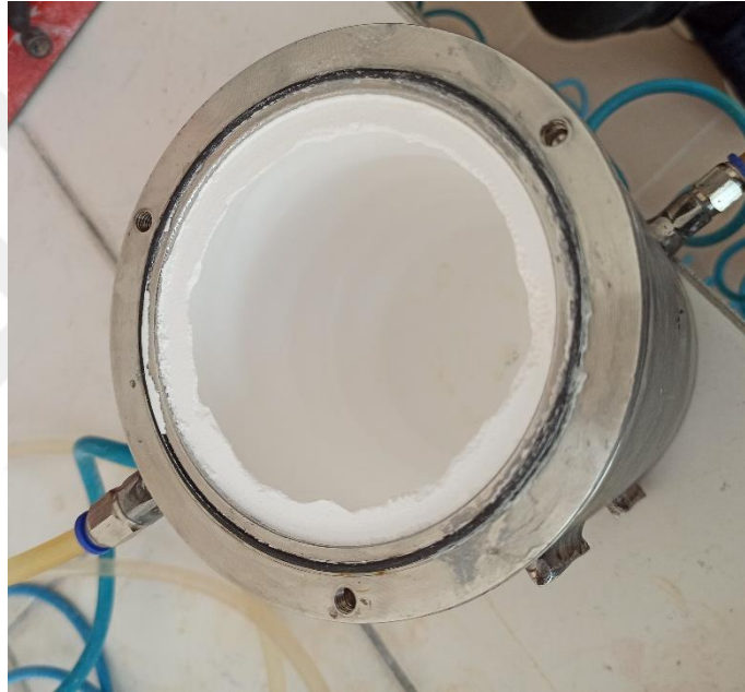
Fotoğraf 4.1. 1,5 mm alümina bilya ile yapılan deneyin sonunda değirmen tankının görüntüsü
