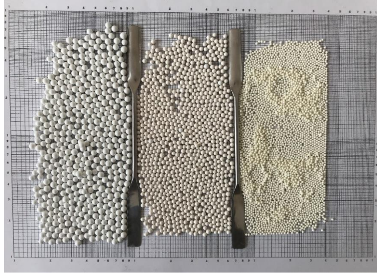
Fotoğraf 3.4. Öğütme testlerinde kullanılan 4 mm, 3 mm, 1,5 mm alümina bilyalar
