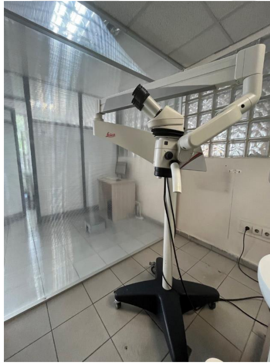
Şekil 2.1. Örneklerin seçilmesinde ve hazırlanmasında kullanılan dental mikroskop (Leica M320 , Wetzlar, Germany)
