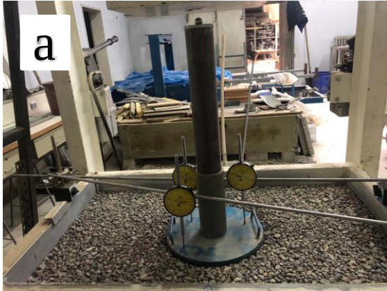
Resim 3.6. RD=%46 Geocell-33-1,5 çakıl (2.tabaka): a) yükleme öncesi, b) yükleme sonrası
