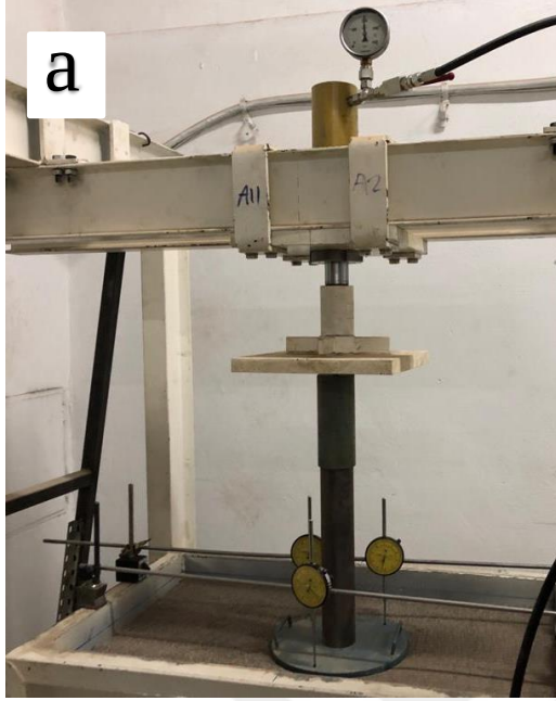
Resim 2.5. RD=%71 Geocell-60-1,0 kum (1.tabaka): a) yükleme öncesi, b) yükleme sonrası
