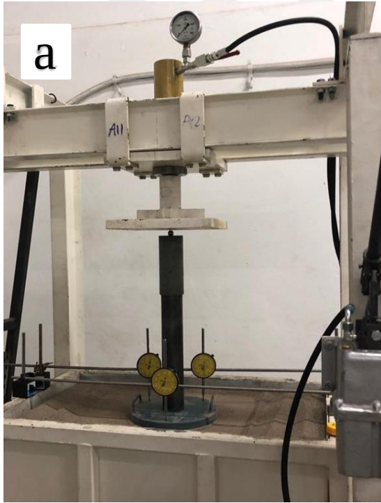
Resim 2.12. RD=%74 Geocell-33-1,5 kum (2.tabaka): a) yükleme öncesi, b) yükleme sonrası
