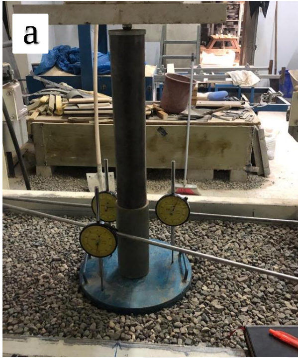
Resim 3.7. RD=%66 Geocell-33-1,5 akıl (1.tabaka): a) ykleme ncesi, b) ykleme sonrası
