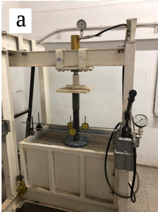
Resim 2.6. RD=%76 Geocell-60-1,0 kum (2.tabaka): a) yükleme öncesi, b) yükleme sonrası
