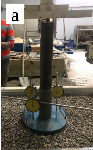
Resim 3.5. RD=%44 Geocell-33-1,5 çakıl (1.tabaka): a) yükleme öncesi, b) yükleme sonrası
