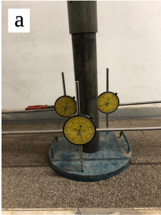
Resim 2.9. RD=%72 Geocell-40-1,5 kum (1.tabaka): a) yükleme öncesi, b) yükleme sonrası
