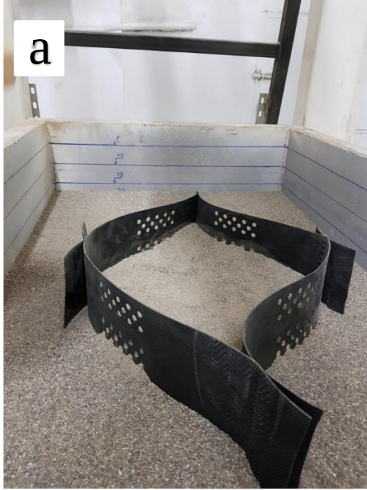
Resim 2.3. RD=%73 Geocell-60-1,0 tek hücreli kum: a) hücrenin yerleştirilmesi, b) yükleme sonrası
