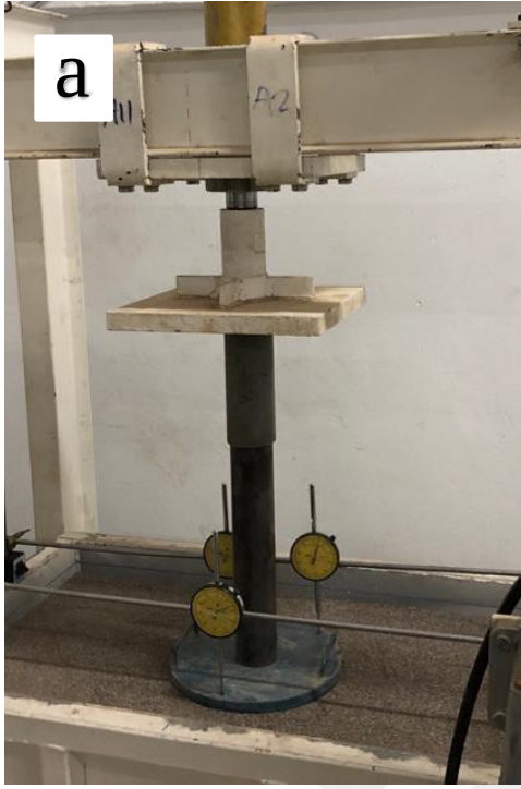
Resim 2.7. RD=%77 Geocell-60-2,0 kum (1.tabaka): a) yükleme öncesi, b) yükleme sonrası
