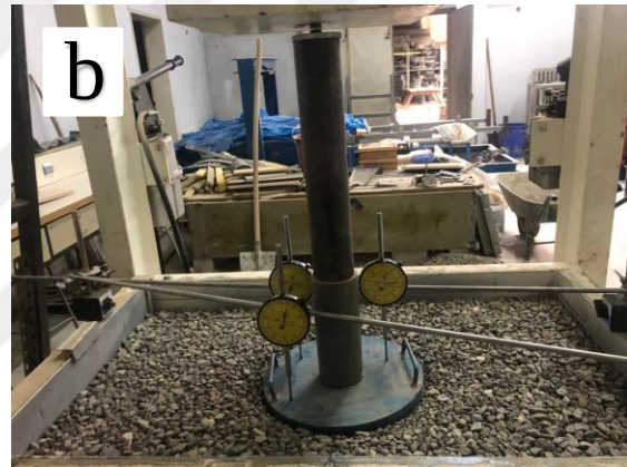
Resim 3.4. RD=%45 Geocell-60-2,0 çakıl (2.tabaka): a) yükleme öncesi, b) yükleme sonrası
