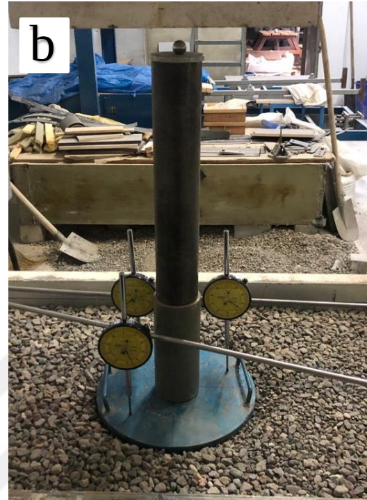
Resim 3.7. RD=%66 Geocell-33-1,5 akıl (1.tabaka): a) ykleme ncesi, b) ykleme sonrası
