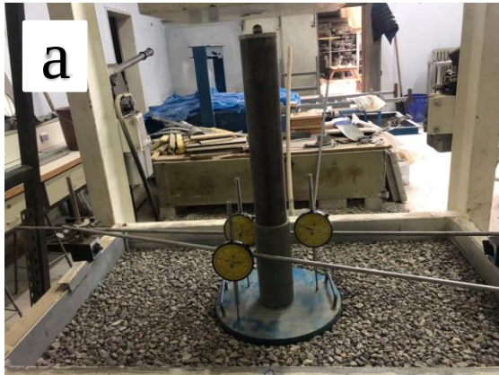
Resim 3.8. RD=%66 Geocell-33-1,5 akıl (2.tabaka): a) ykleme ncesi, b) ykleme sonrası
