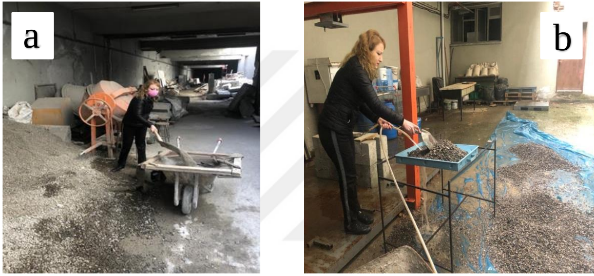
Resim 3.5. Çakıl numune hazırlama detaylarından bir görünüş: a) çakılın elenmesi, b) çakılın yıkanması
