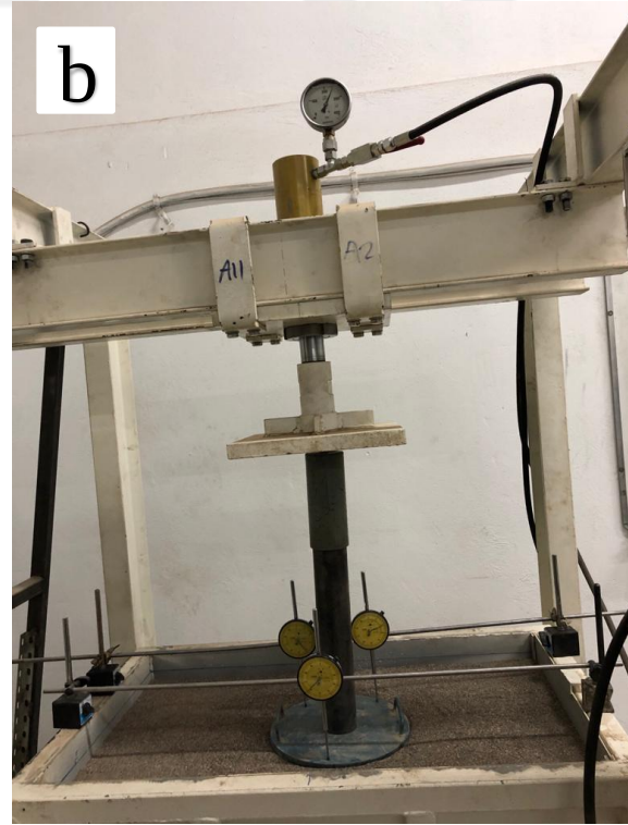
Resim 2.8. RD=%73 Geocell-60-2,0 kum (2.tabaka): a) yükleme öncesi, b) yükleme sonrası
