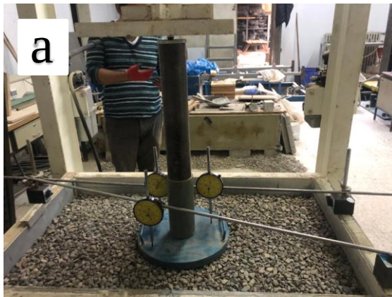
Resim 3.3. RD=%42 Geocell-60-2,0 çakıl (1.tabaka): a) yükleme öncesi, b) yükleme sonrası
