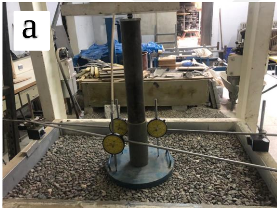
Resim 3.4. RD=%45 Geocell-60-2,0 çakıl (2.tabaka): a) yükleme öncesi, b) yükleme sonrası
