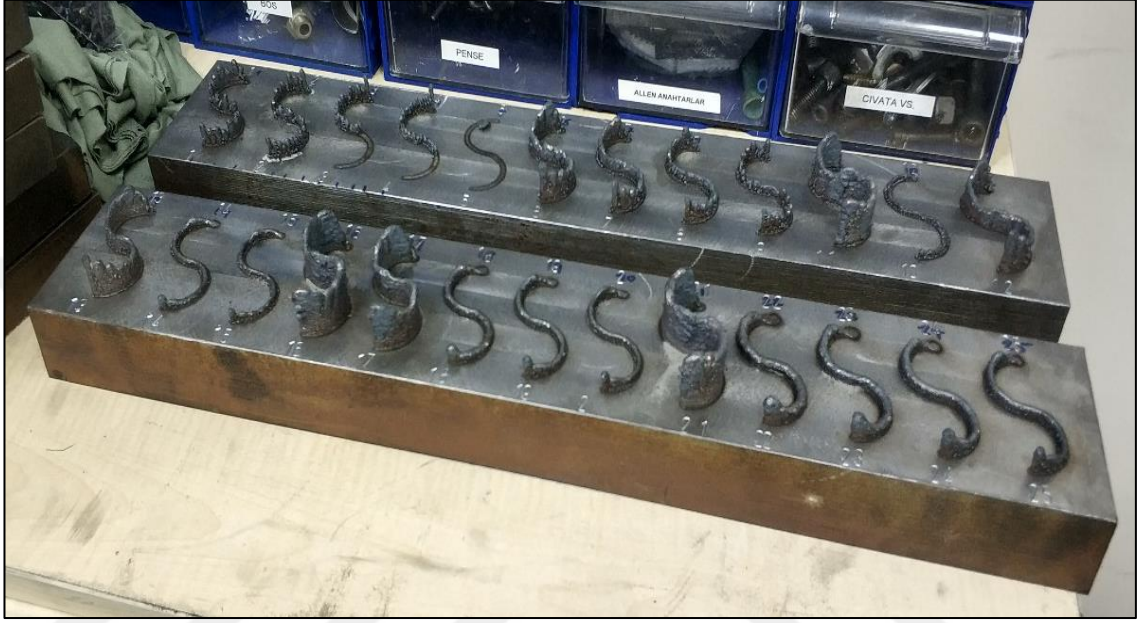
Şekil 2.12. DED yöntemi için proses parametresi tayininde Taguchi uygulaması
